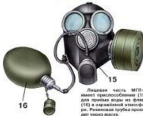
Лицевая часть МГО-8 имеет приспособление (15) для приема воды из флажки (16) в зараженной атмосфере. Разновидная трубка проходит через маску.
