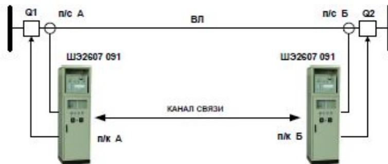
В терминалах, установленных на разных концах ВЛ осуществляется синхронизация моментов взятия цифровых отсчетов аналоговых сигналов (прежде всего фазных токов) и синхронизация цифровой обработки сигналов.
