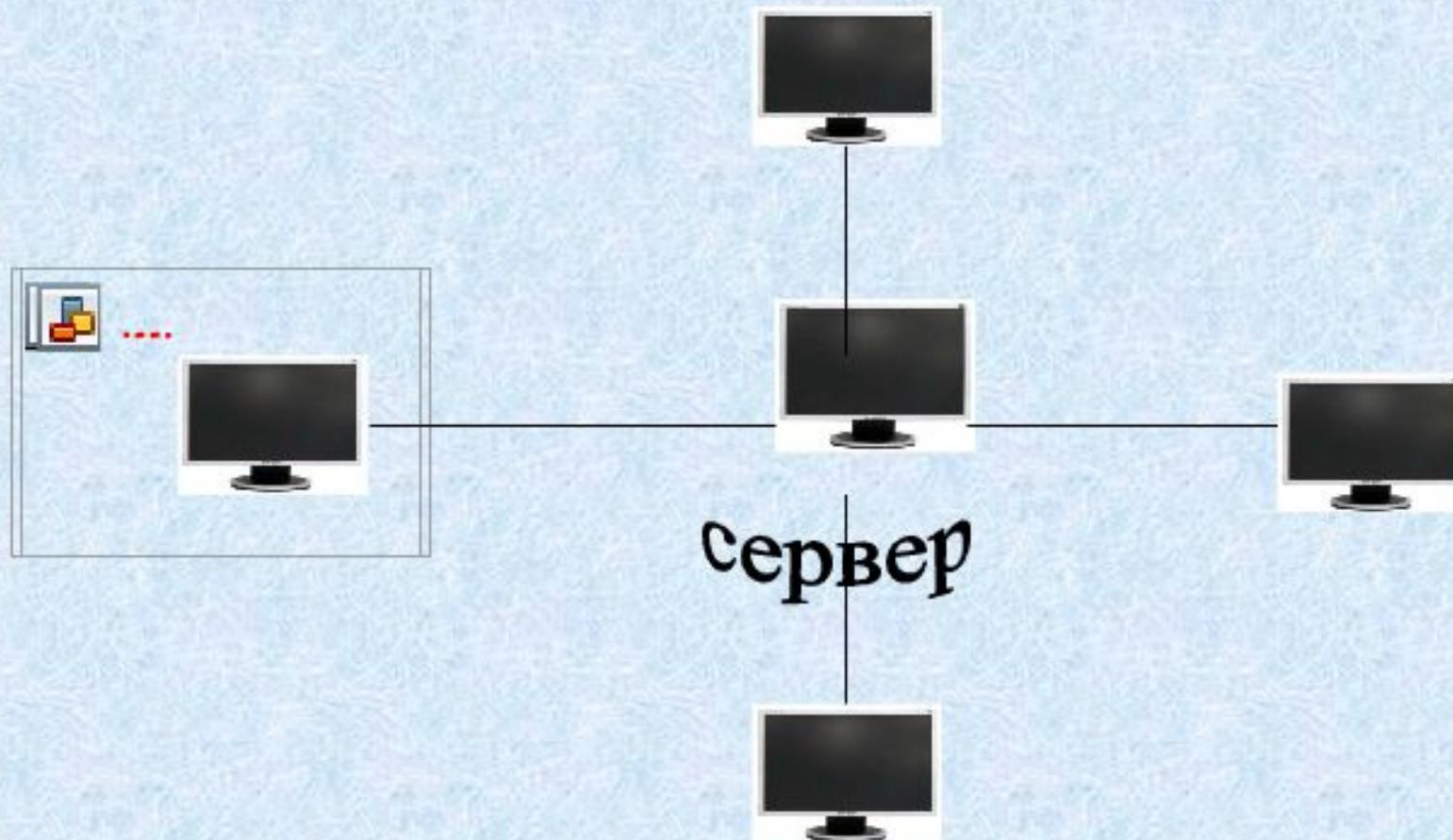
Используется отдельный кабель для каждого компьютера, проложенный от центрального устройства.
