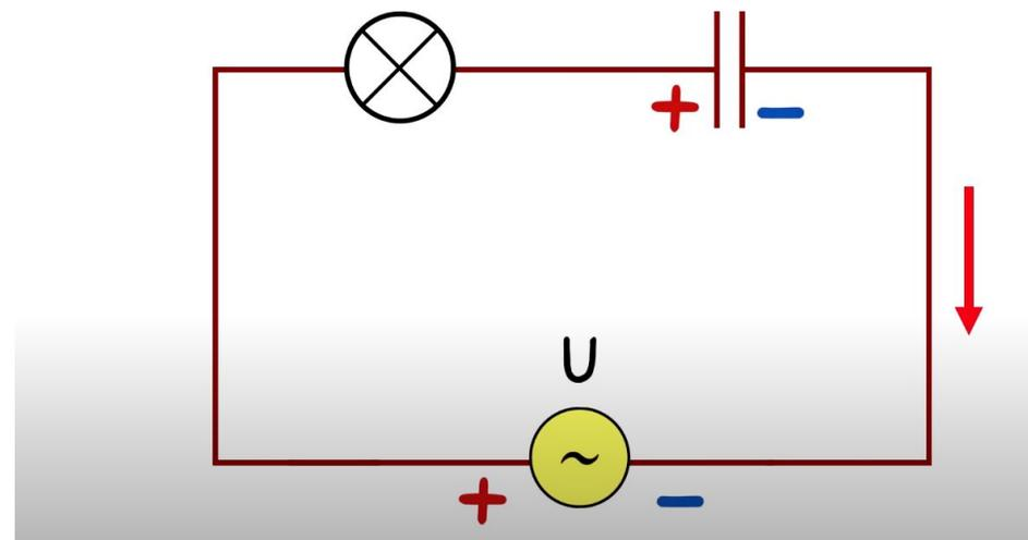
В цепи переменного тока, содержащий конденсатор, происходит периодическая зарядка и разрядка конденсатора под действием переменного напряжения
