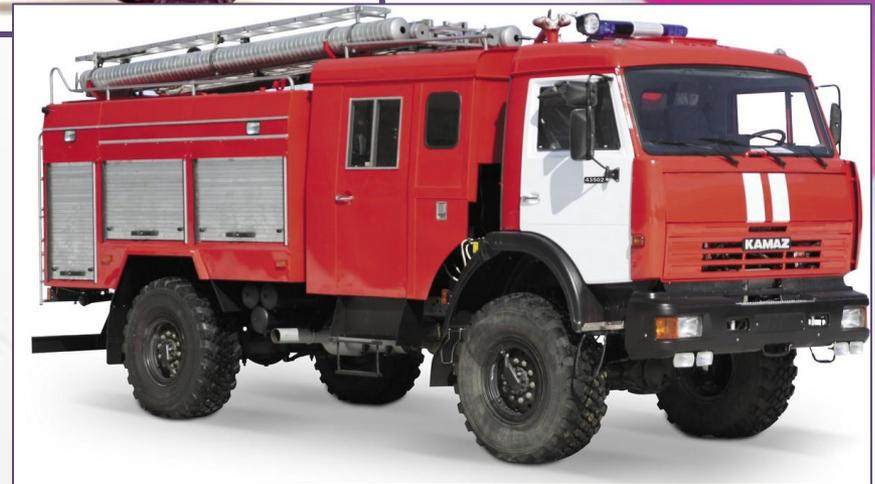
**Пожарный автомобиль** — оперативное транспортное средство, которое оснащено пожарно-техническим вооружением, оборудованием и используется при пожарно-спасательных работах
