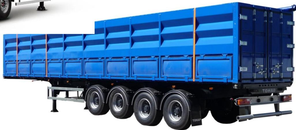
**Полуприцеп** – это разновидность прицепа, которому необходимо передней частью опираться на тягач, так как он не в состоянии самостоятельно удерживать равновесие.
