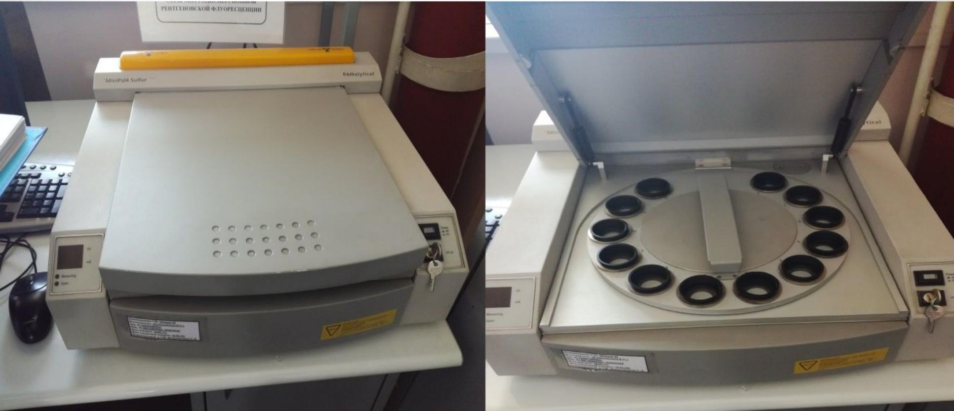
Рисунок 6 – Рентгенофлуоресцентная спектрометрия PW4025 MiniPal
