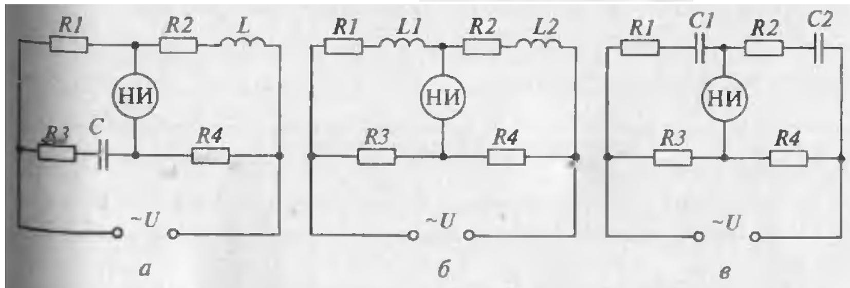
Рис. Схемы мостов с реактивными сопротивлениями: в противоположных (а) и смежных (б, в) плечах
