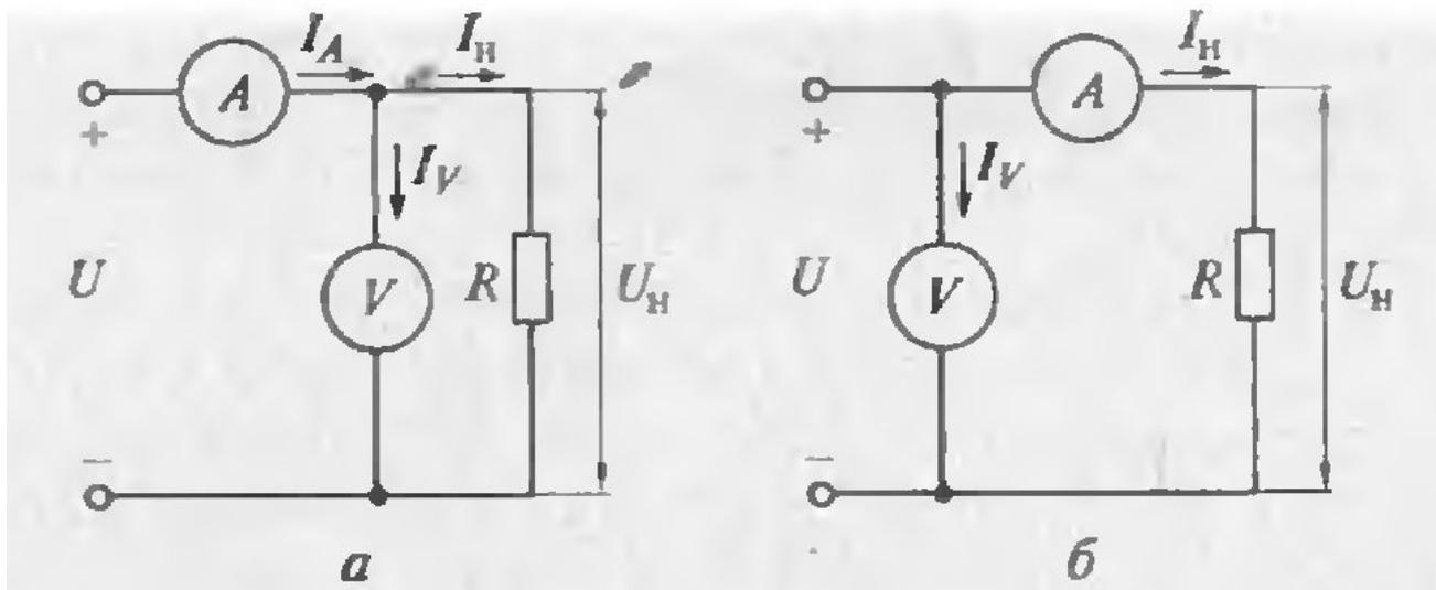
Рис. Схемы измерения мощности по показаниям вольтметра и амперметра при малых (а) и больших (б) сопротивлениях нагрузки
