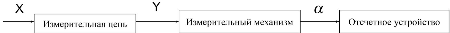
***Измерительная цепь:*** обеспечивает преобразование электрической измеряемой величины  $X$  в промежуточную величины  $Y$ .
