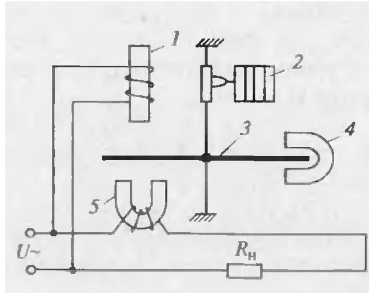
Рис. Схема однофазного индукционного счетчика: 1 – катушка напряжения; 2 – катушка тока; 3 – алюминиевый диск; 4 – постоянный магнит; 5 – П-образный сердечник
