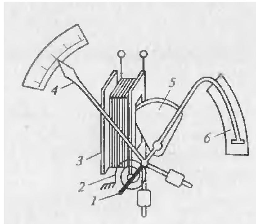
Рис. Схема устройства электромагнитного прибора:
