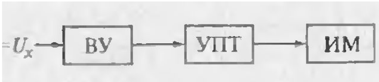
Рис. Структурная схема электронного вольтметра постоянного тока.
