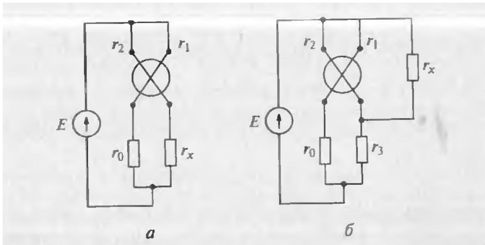
Рис. Схемы устройства магнитоэлектрических омметров с логометрическим механизмом для измерения больших (а) и малых (б) сопротивлений
