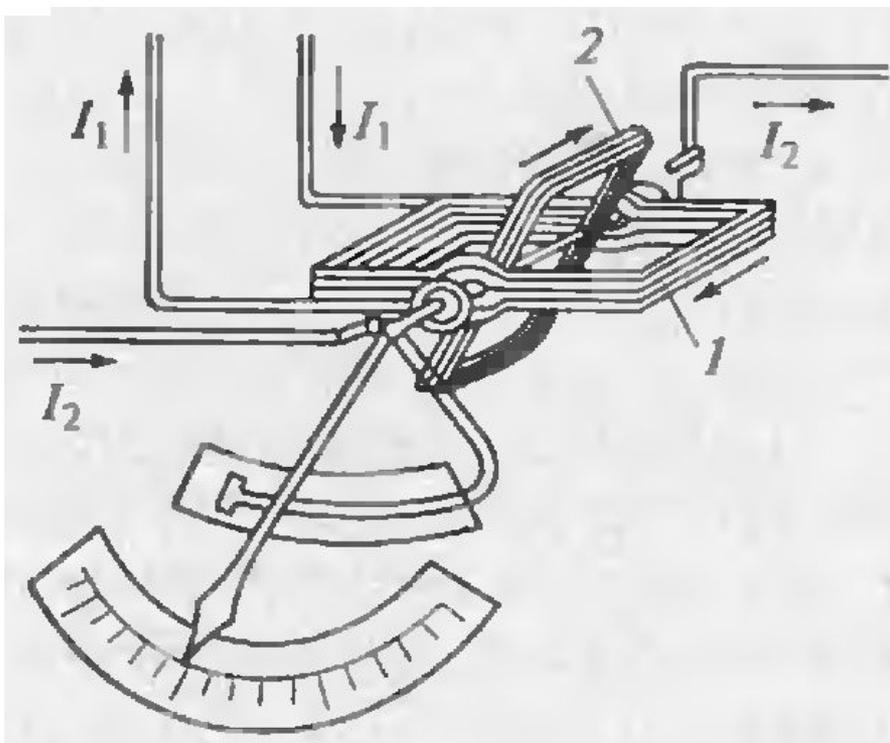
Рис. Схема устройства электродинамического прибора:
