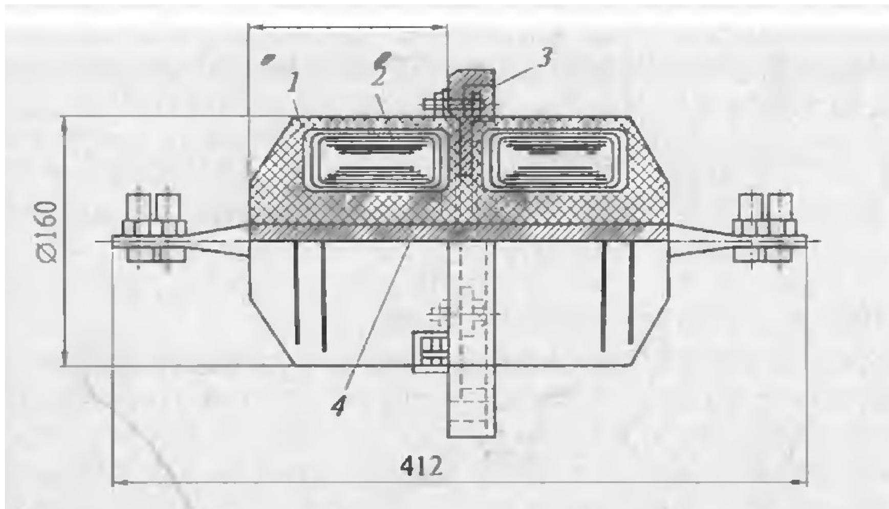
Рис. Одновитковый трансформатор тока ТПОЛ-10,  $U_{ном} = 10кВ$
