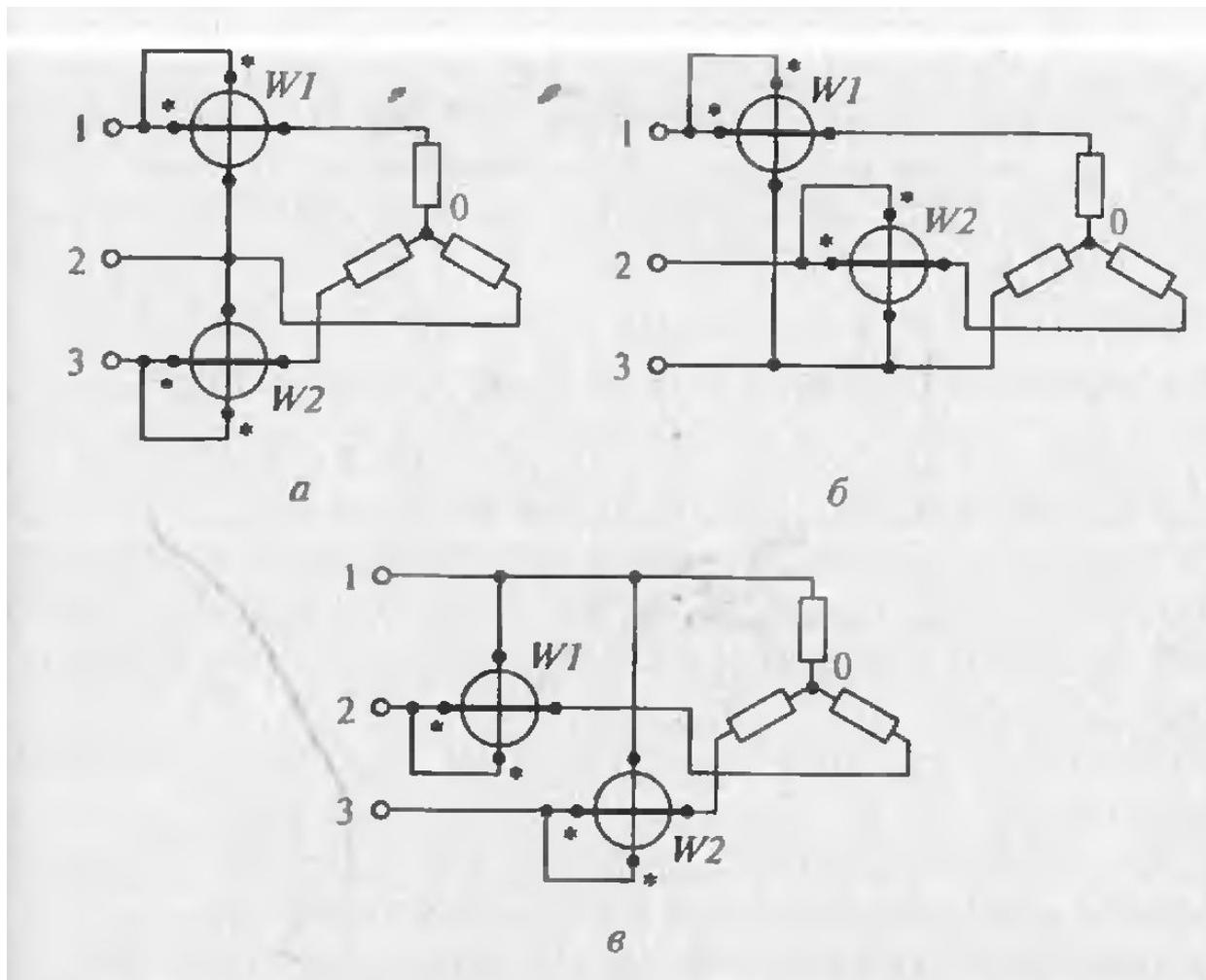
Рис. Схемы включения двух ваттметров в трехфазную цепь:
