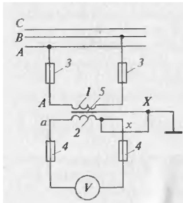
Рис. Схема включения однофазного трансформатора напряжения:
