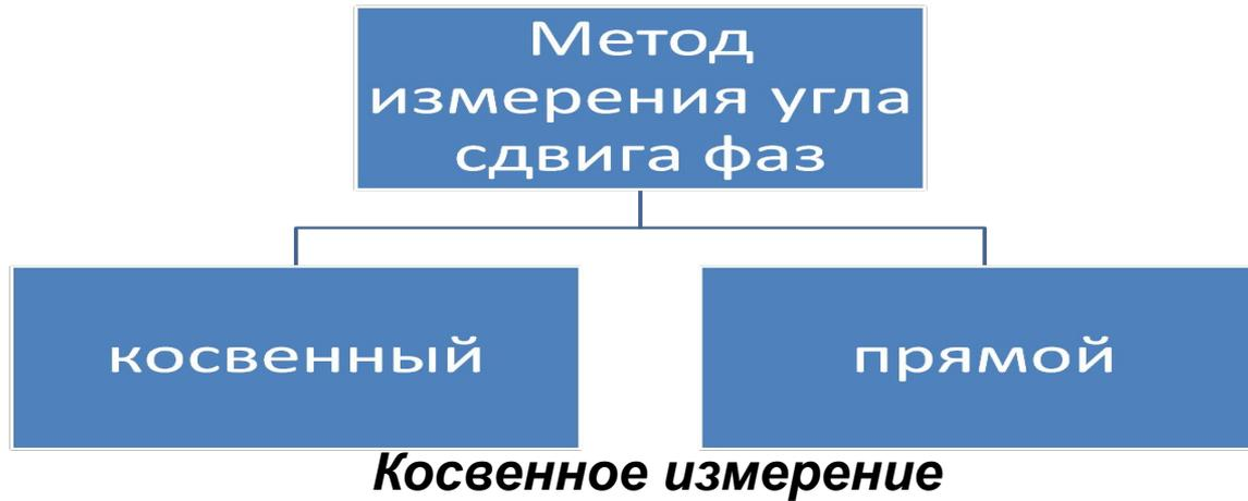
Такое измерение угла сдвига фаз между напряжением  $U$  и током  $I$  в нагрузке в однофазных цепях, которое осуществляют с помощью трех приборов — вольтметра, амперметра и ваттметра
