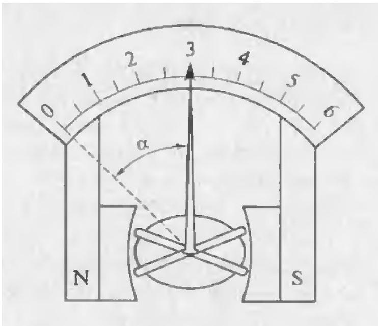
Рис. Схема устройства магнитоэлектрического логометра
