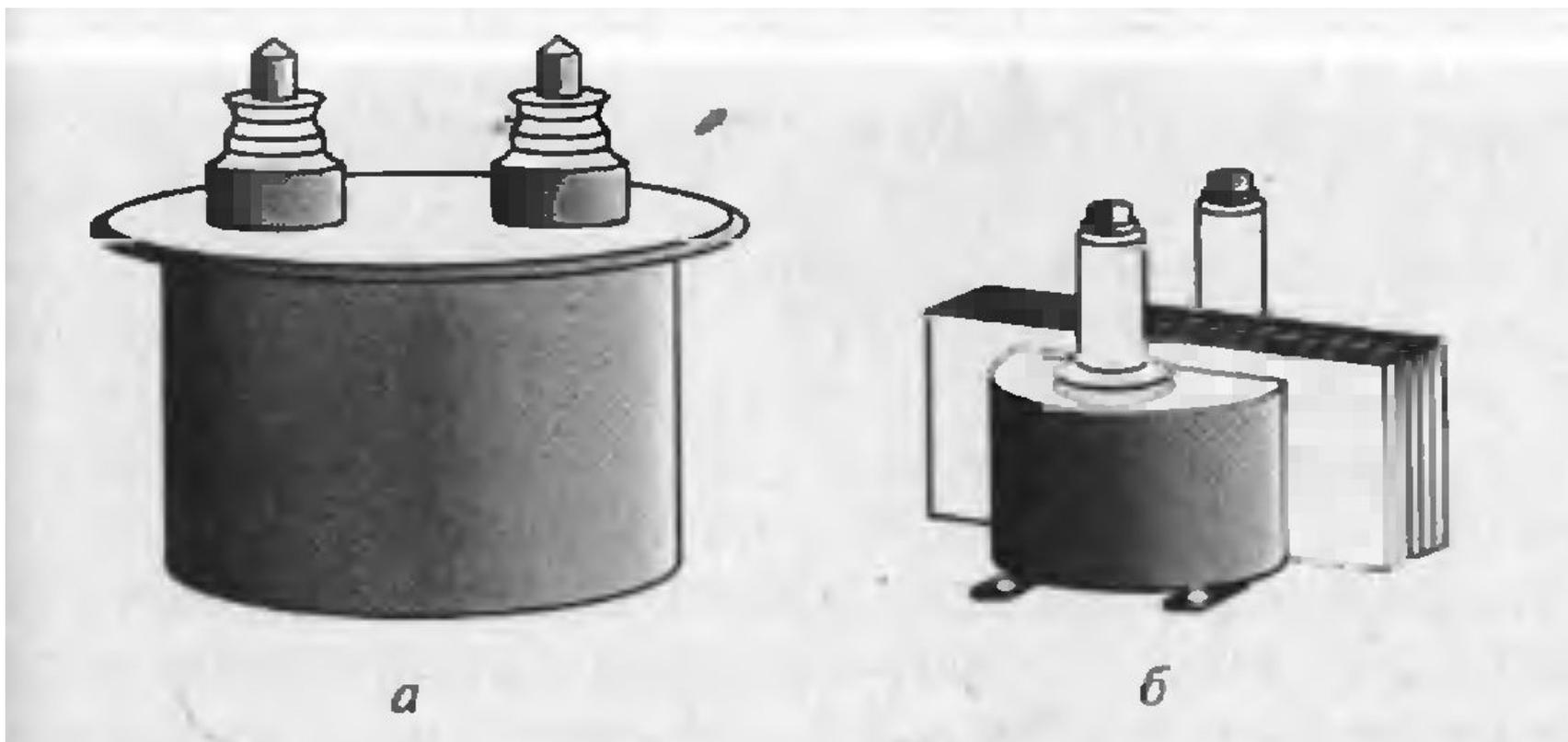
Рис. Внешний вид однофазных трансформаторов напряжения с масляной изоляцией (а) и литой изоляцией (б)
