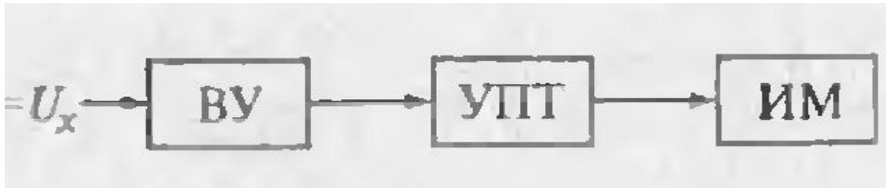
Рис. Структурная схема электронного вольтметра постоянного тока.
