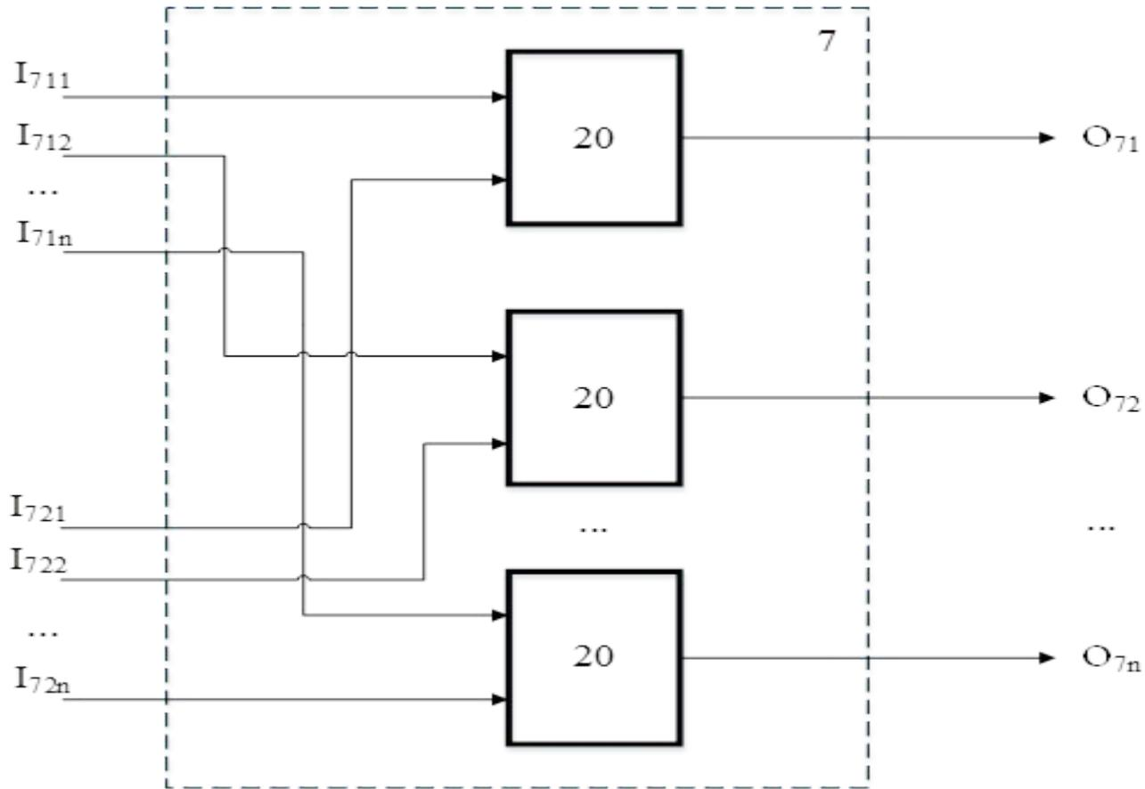
Фиг.6 Структурная схема блока логических элементов И
