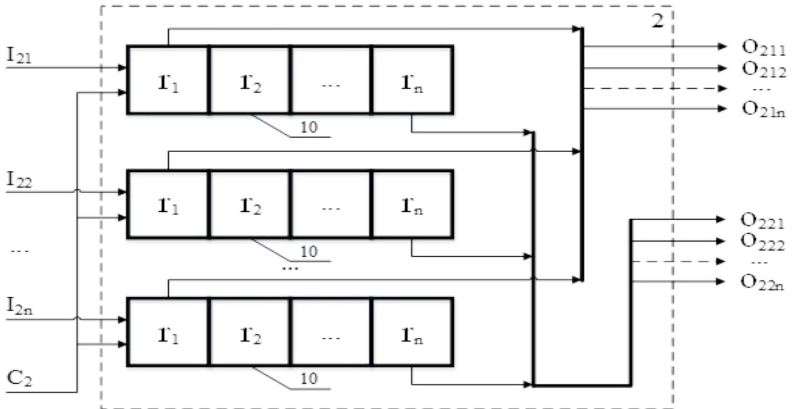
Фиг.3 Структурная схема блока сдвиговых регистров 2
