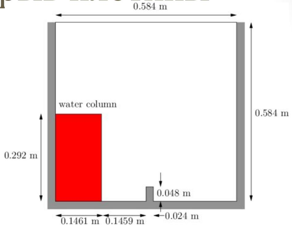
Испытательная установка состоит из столба воды находящегося в состоянии покоя, расположенной позади мембраны, на левой стороне бака. В момент времени  $T = 0$  с, мембрана удаляется, а столб воды падает. Во время распада, вода воздействует на препятствие на дне резервуара и создает сложную структуру потока, в том числе несколько захваченных карманов воздуха. Геометрия и начальная установка показана на рисунке.
