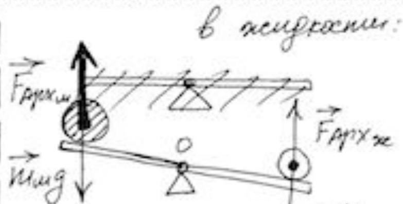
$$F_{\text{арш}} = \rho_{\text{ж}} g \cdot V_{\text{ш}}$$
