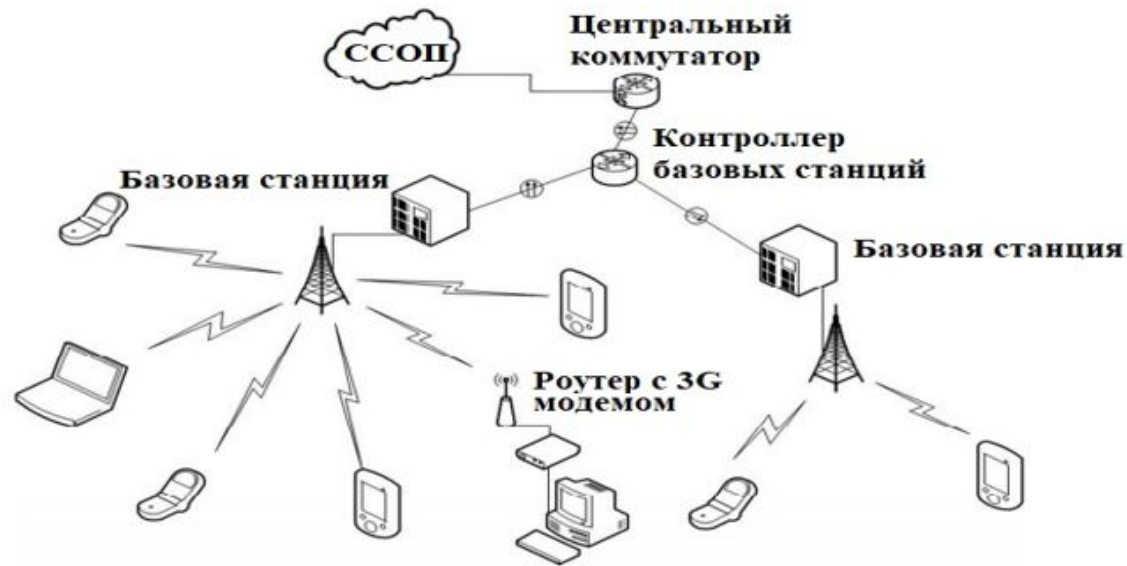
Рисунок 7.2 – Схема организации связи сотового оператора на территории города
