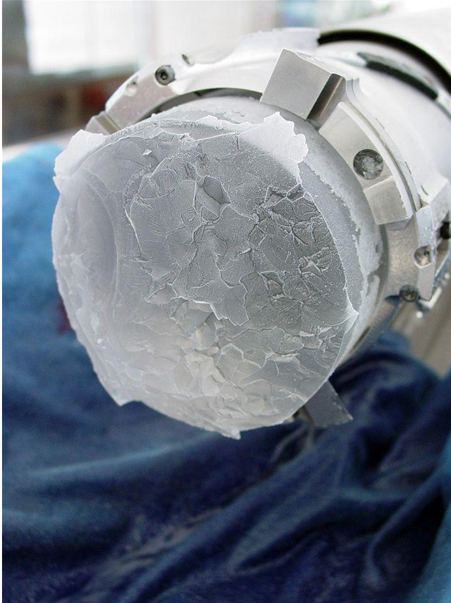
Керн льда из скважины
