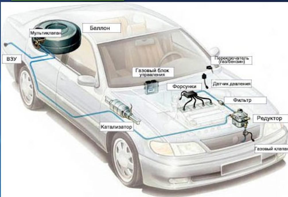
Газовая установка 4-го поколения отличается от предыдущих тем, что является точной копией бензинового инжектора, а именно: каждый цилиндр имеет свою форсунку, подающую рассчитанный необходимый для работы данного цилиндра впрыск газа. А работа форсунок контролируется ЭБУ. При этом ЭБУ принимает непосредственное участие в работе двигателя на ГБО, работая с множеством датчиков необходимых для корректной работы двигателя на газу.
