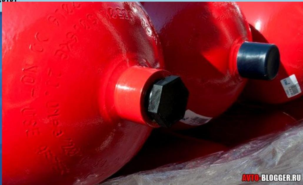
Используется «пропан-бутановая» газовая смесь, также не редко газ «метан». У таких систем есть свой бак, или газовый баллон, устанавливается дополнительно, зачастую в багажник или салон автомобиля. Именно его заполняют газом, который через запорную арматуру поступает в специальное оборудование, которое называется – «испаритель».
