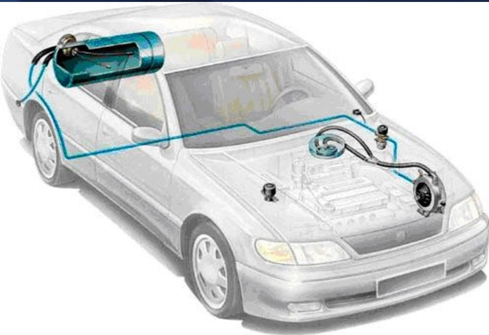
Системы с вакуумным управлением и механическим дозатором газа, которые устанавливают на бензиновые карбюраторные и простые инжекторные автомобили. В первом поколении используются как вакуумные, так и электронные газовые редуктора. Без лямбда-зонда.
