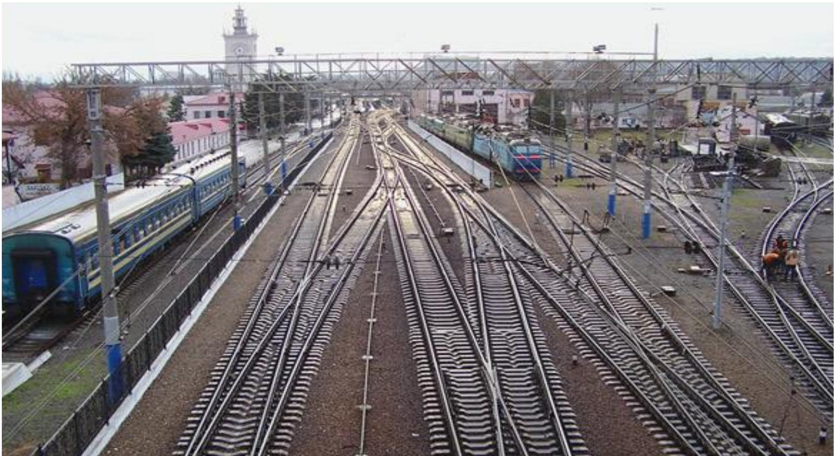
Станции, разъезды и обгонные пункты должны располагаться на горизонтальной площадке. В отдельных случаях допускается расположение их на уклонах - не круче  $0,0015$ , а в трудных топографических условиях проектирования - не круче  $0,0025$
