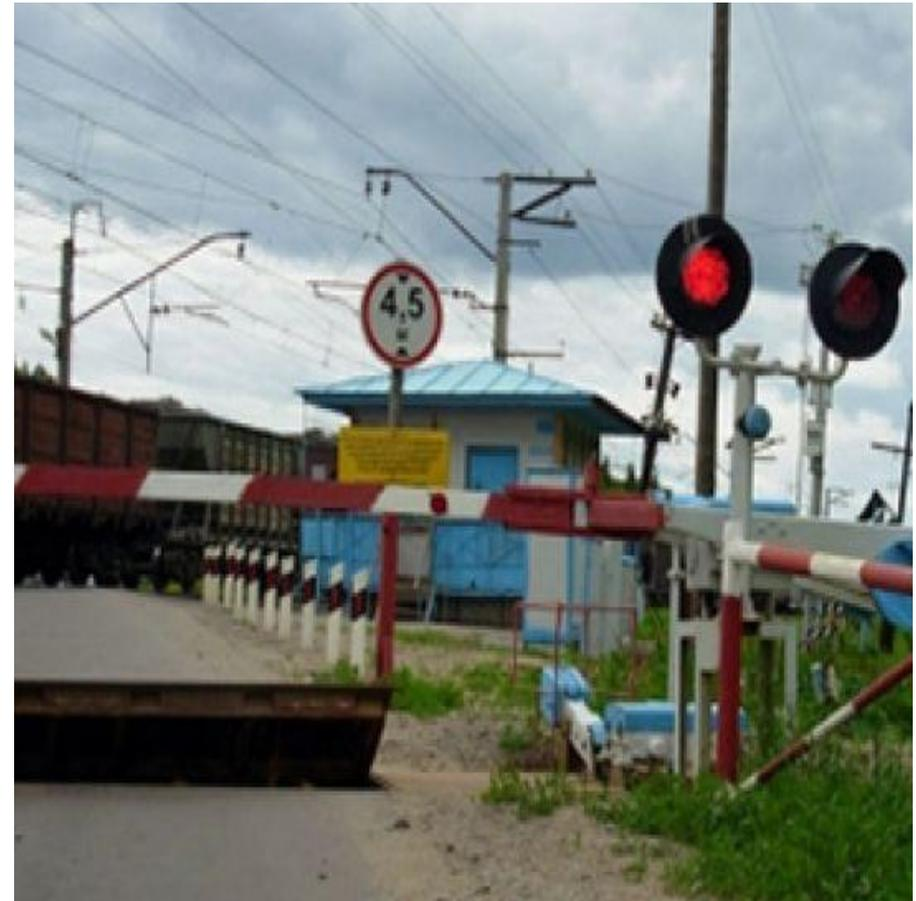
Автоматическая переездная сигнализация должна продолжать действовать, а автоматические шлагбаумы должны оставаться в закрытом положении до полного освобождения переезда поездом
