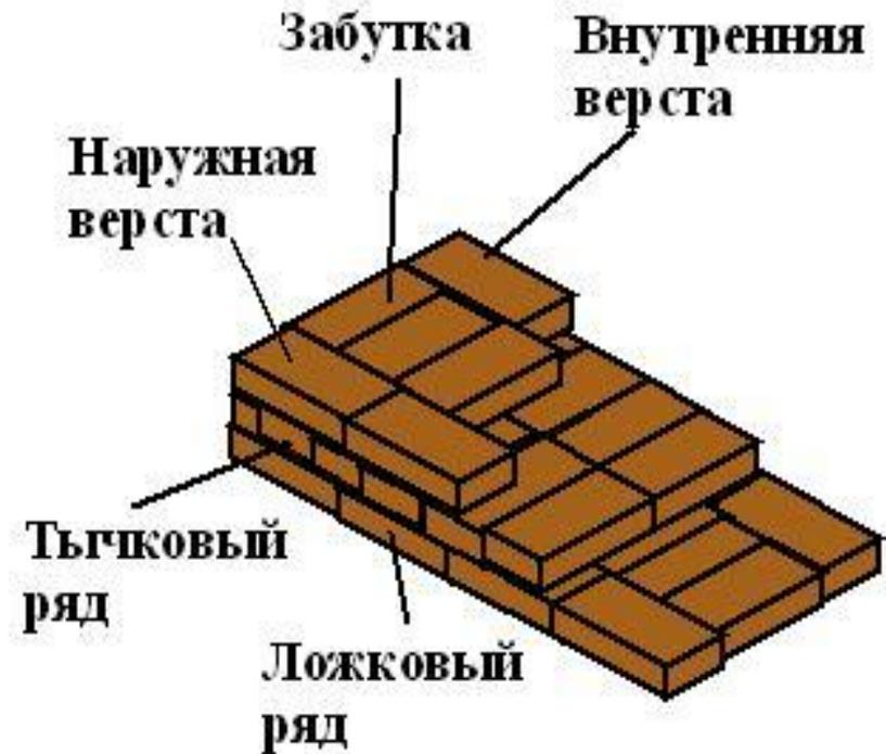
**Элементы стен сплошной кладки**
