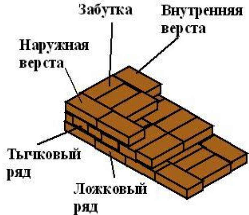
Элементы стен сплошной кладки
