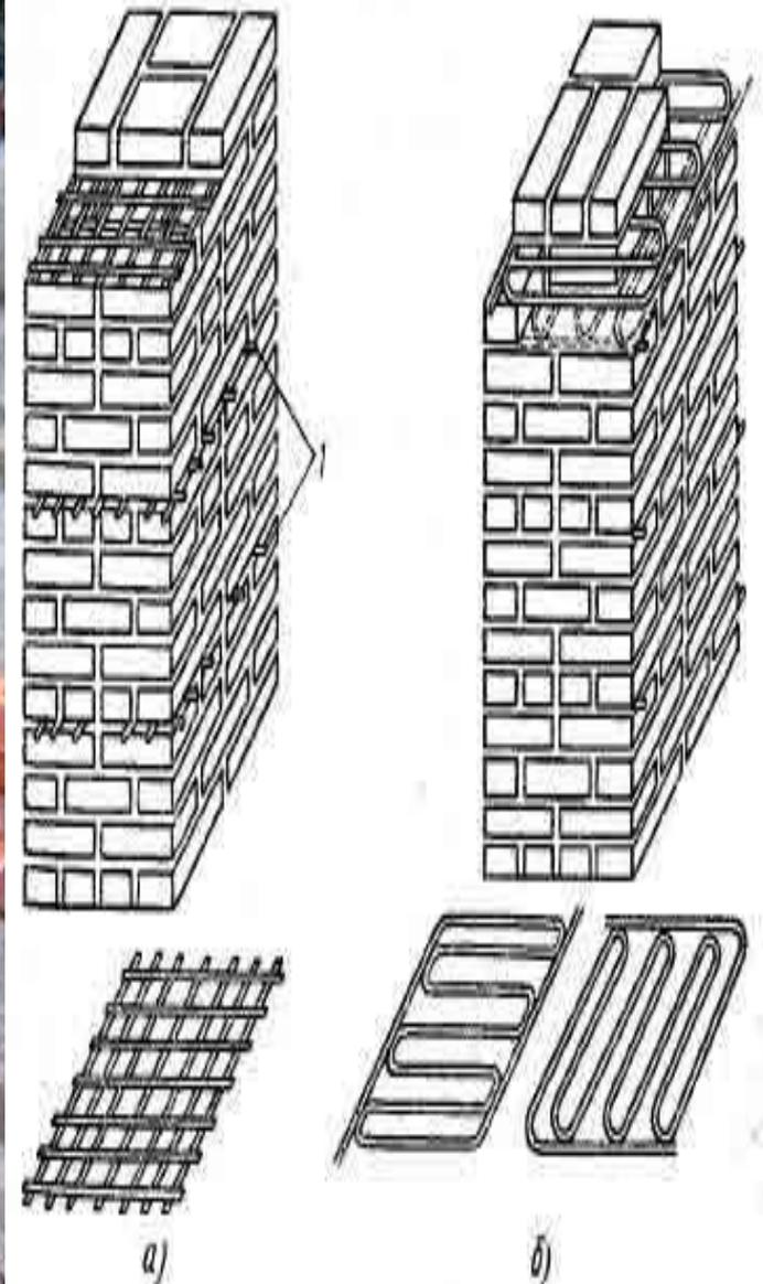
Рис. 60. Армирование кирпичных столбов прямоугольными (а) и зигзагообразными сетками (б) (1 – арматура)
