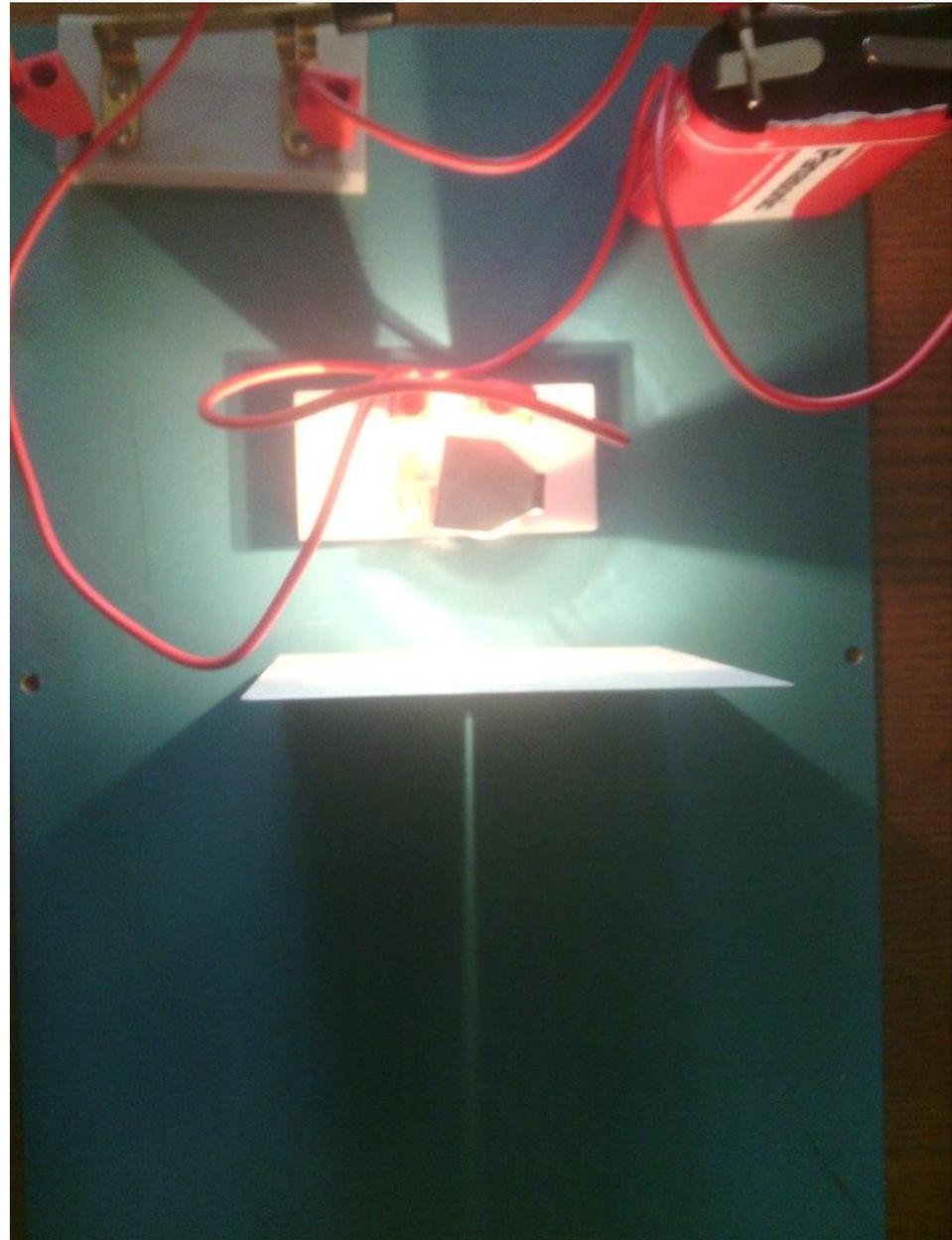
3. Вплотную к экрану со стороны, противоположной лампе, расположите лимб так, чтобы луч света, скользя по его поверхности, проходил через оба деления, отмеченные цифрами 0.
