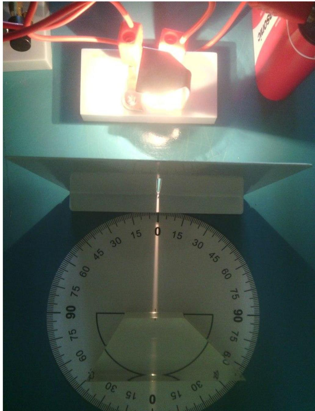
6. Занесите в таблицу исходные значения угла падения и угла преломления света на поверхности призмы.
