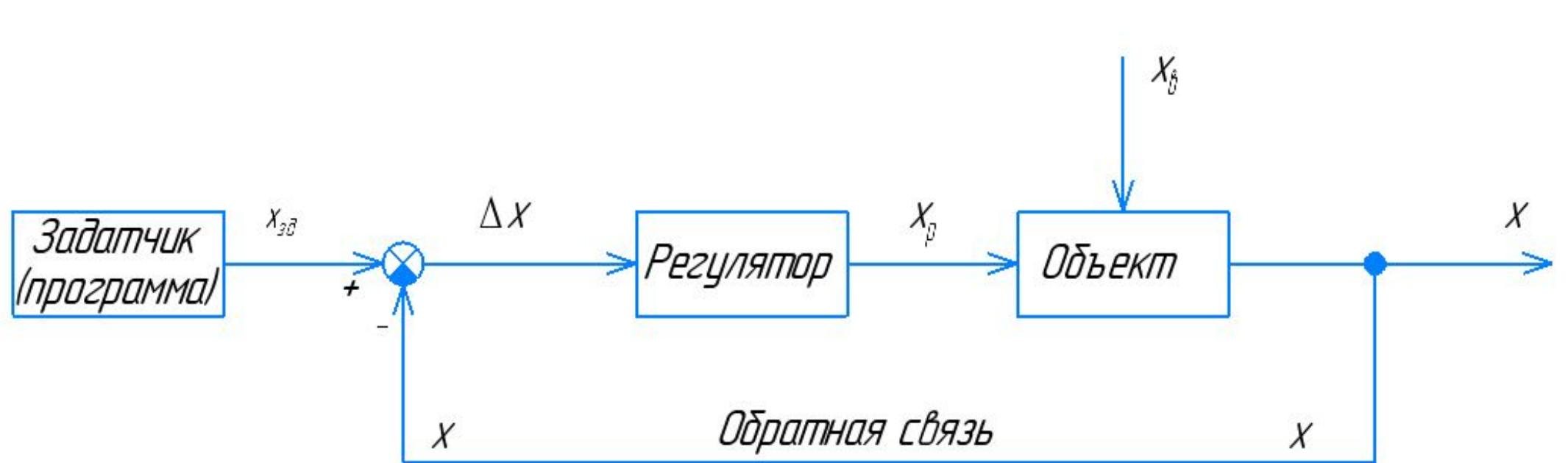
Рис. 2. Блок-схема замкнутой системы автоматического регулирования.
