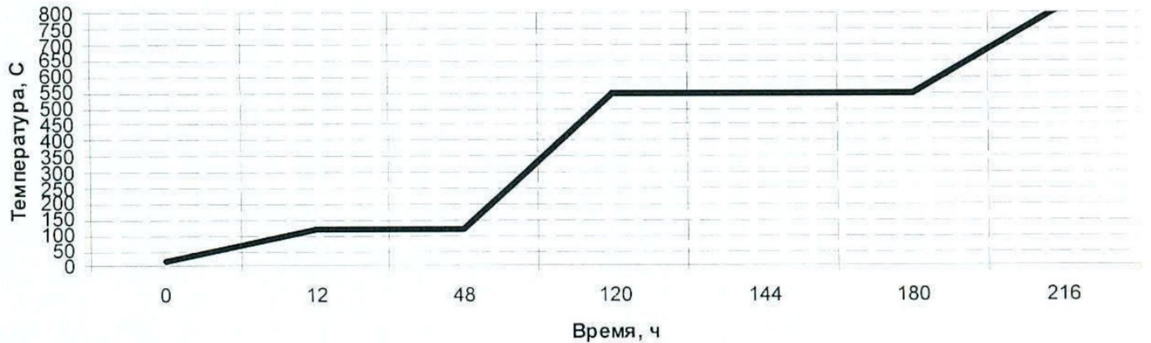
Рис. 1. График сушки и разогрева миксера печи СКН.
