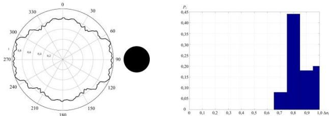
Нормированная диаграмма обратного отражения в азимутальной плоскости (слева) и гистограмма распределения отражающей способности шара (справа) (эксперимент)
