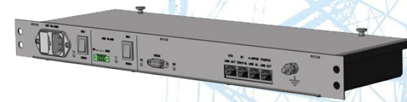
Система сбора информации с РП/ТП, по ЛЭП 6-10 «ССТП»
