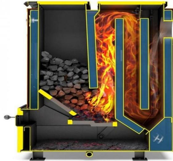
**Топкой или топочным устройством называется часть котла, предназначенная для сжигания топлива с целью преобразования его химической энергии в тепло**
