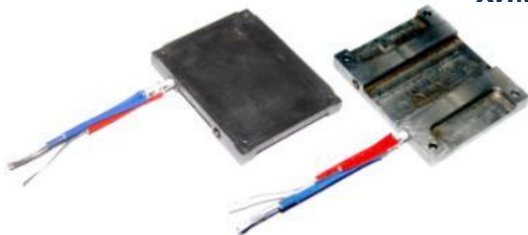
Конструкция платформы системы нагрева массива сенсоров.
