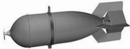
Зажигательная авиационная бомба с твердым горючим ЗАБ-50тг индекс 7-3-251 чертеж 3-0445 (1938г.)
