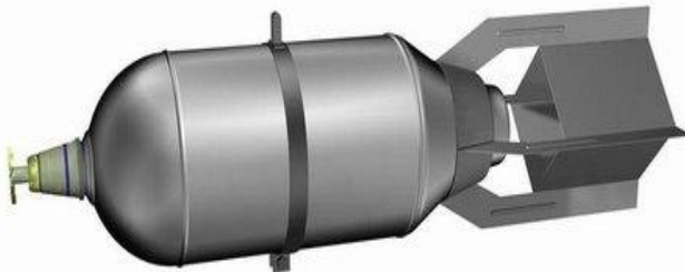
Зажигательная авиационная бомба с термитными шарами ЗАБ-100-65тш индекс 8-3-157 чертеж 3-01026 (1941г.)
