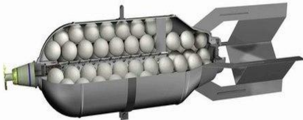
Зажигательная авиационная бомба с твердым горючим ЗАБ-50тг индекс 7-3-251 чертеж 3-0445 (1938г.)
