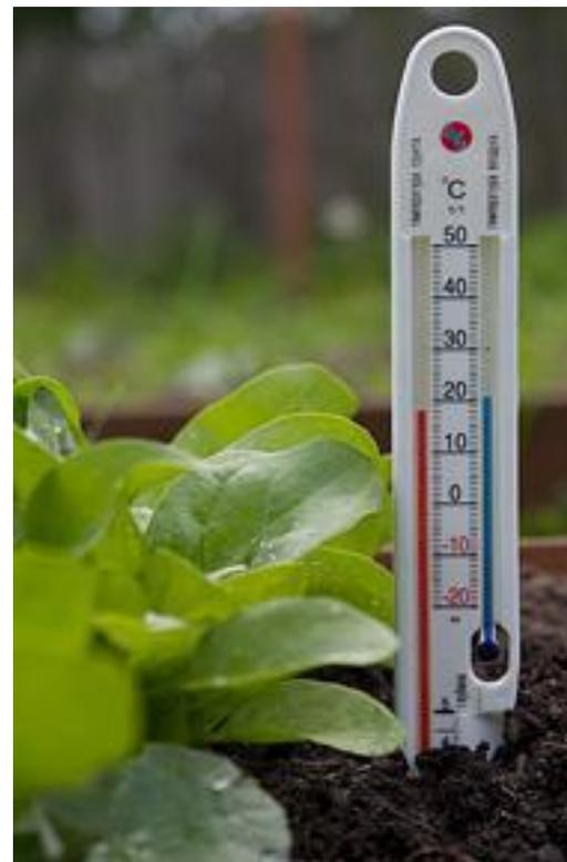
Для измерения температуры почвы применяют ртутные, спиртовые, толуоловые, биметаллические, электрические и другие термометры в зависимости от цели наблюдений. На метеорологических станциях, постах и обсерваториях для измерения температуры поверхности почвы используют:
