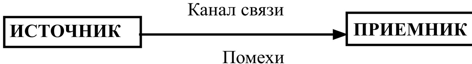
**Канал связи - совокупность технических устройств, обеспечивающих передачу сигнала от источника к получателю.**
