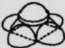
купол на парусах с погашением распора боковыми полукуполами
