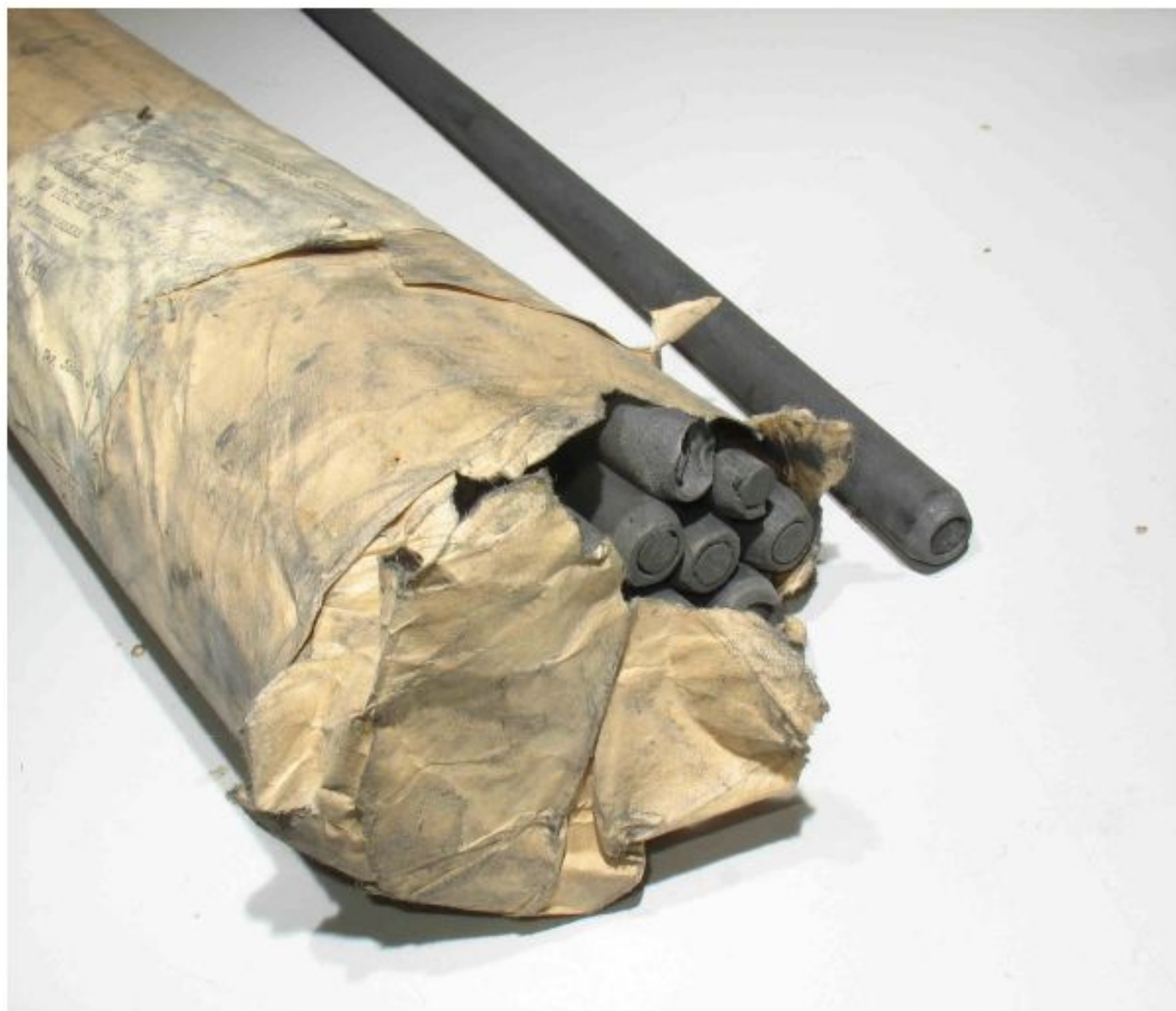
Рисунок 3.3 Электроды от дуговой лампы, использовавшейся для киносъемок. Марка электродов КСБ — Уголь КиноСъемочный Белопламенный неомеднённый.
