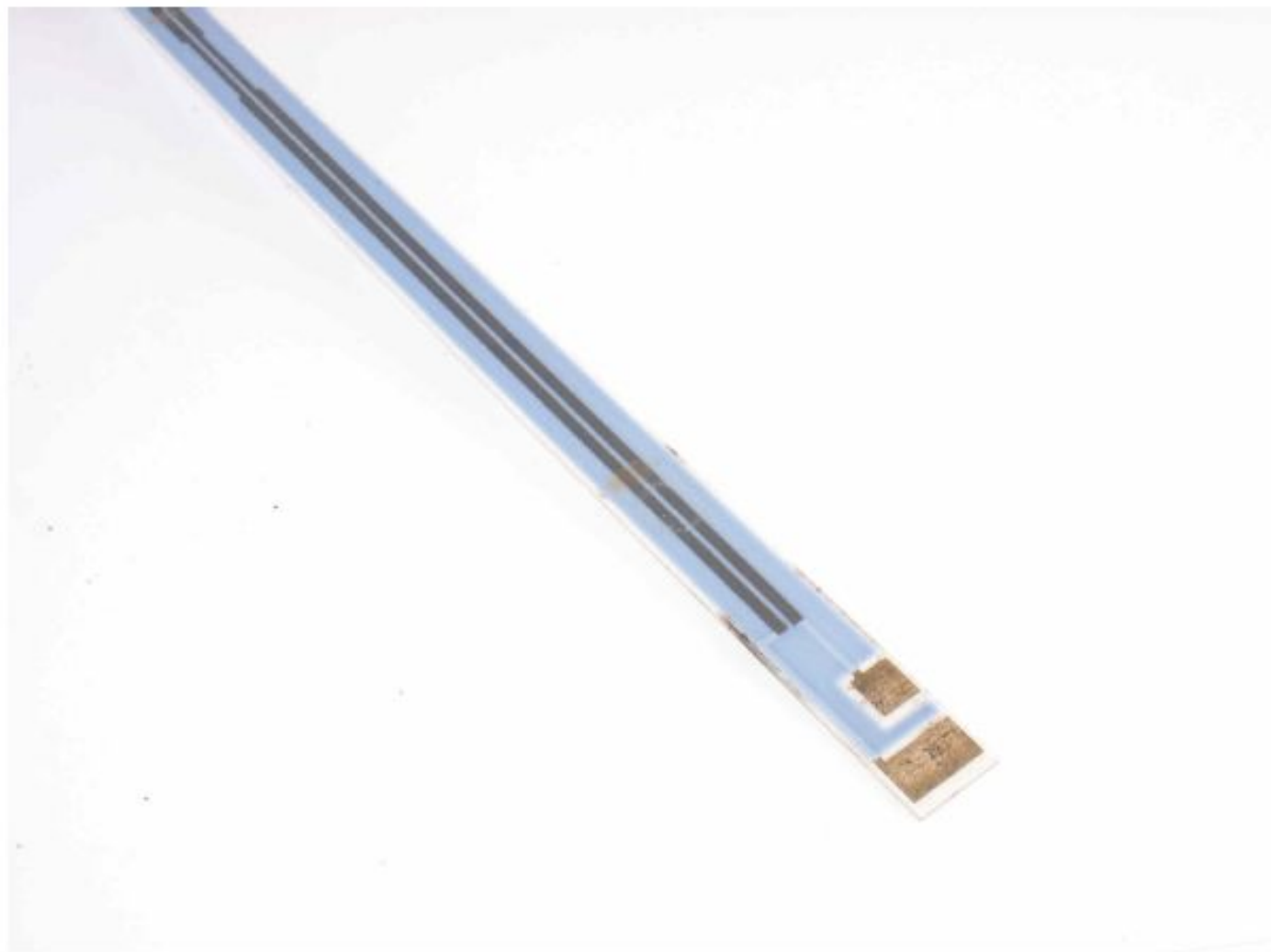
Рисунок 3.2 Нагреватель от печки лазерного принтера. Основа — фарфор, проводники — серебро. Нагреватель — углеродная композиция, покрыта для защиты слоем глазури.
