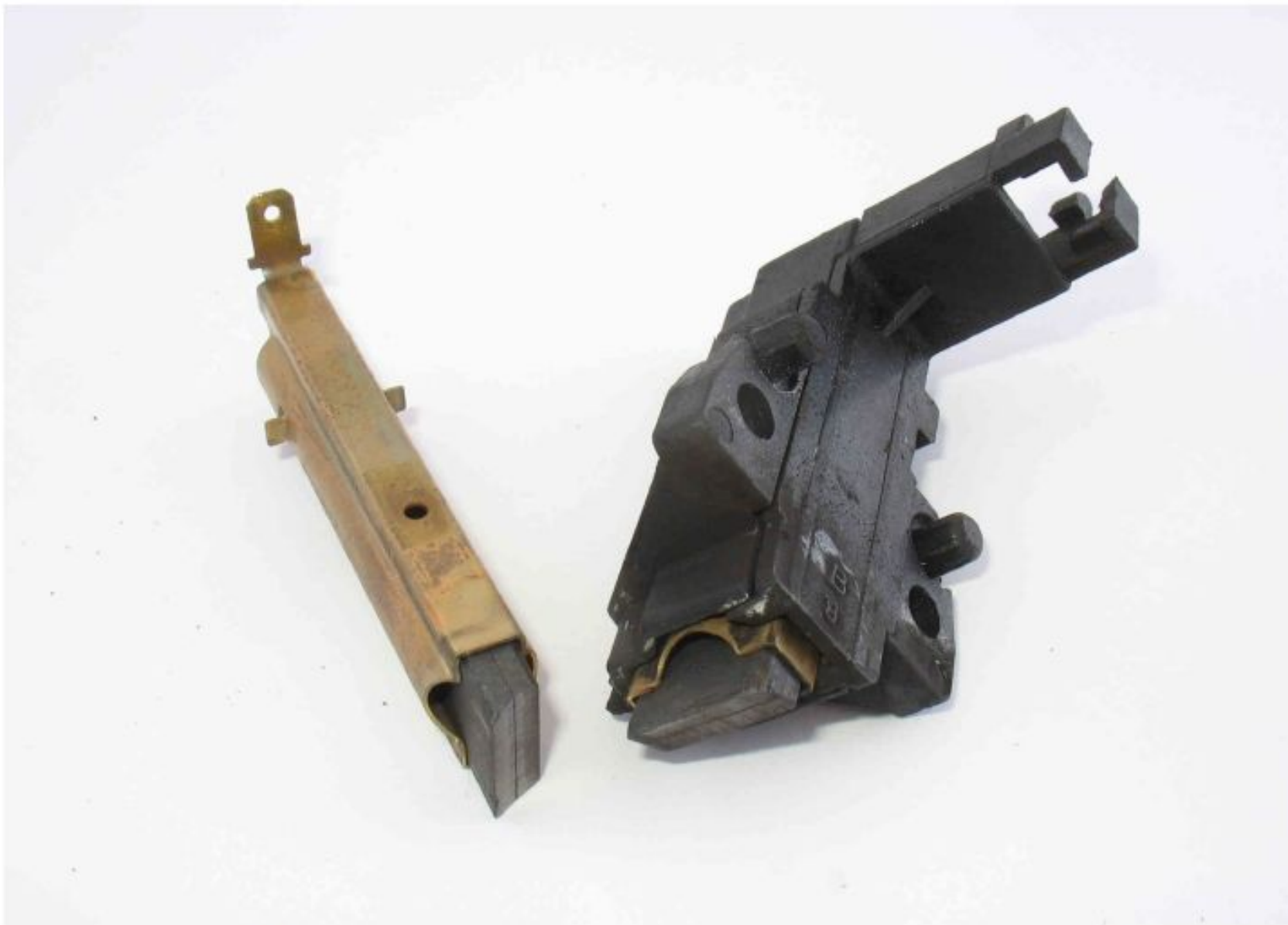
Рисунок 3.4 Изношенные щетки от двигателя стиральной машины. Плохой контакт щеток с коллектором — причина повышенного искрения.
