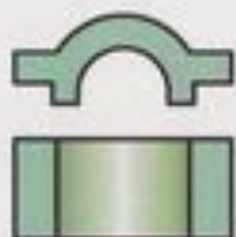
а - неразъемная деревянная модель
