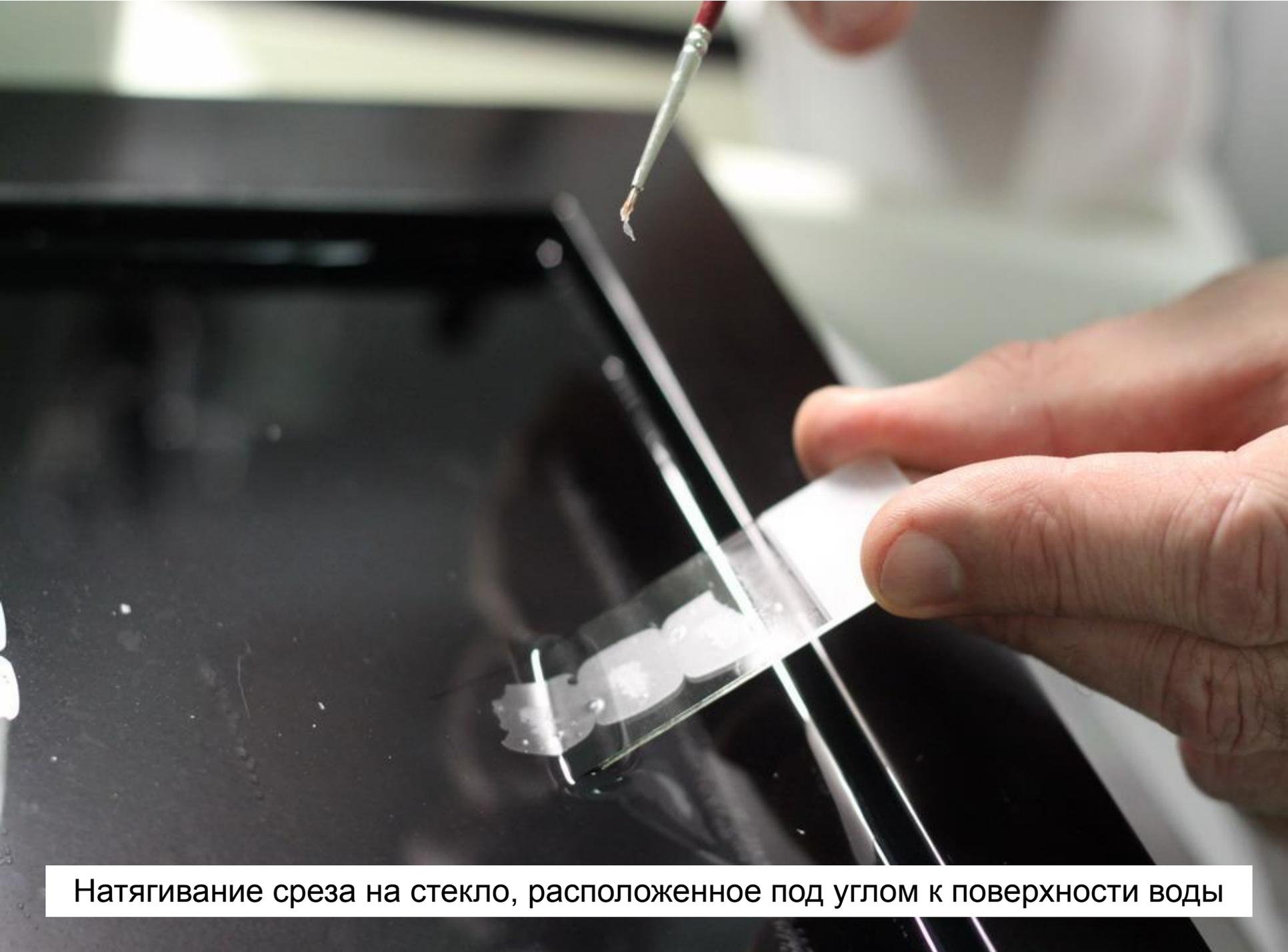
Натягивание среза на стекло, расположенное под углом к поверхности воды
