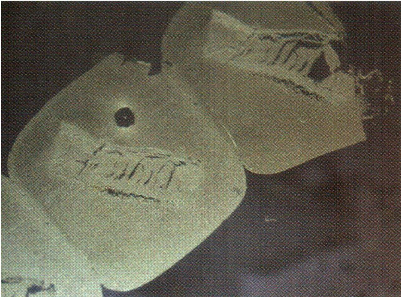
Перерастяжение и разрывы срезов на поверхности водяной бани
