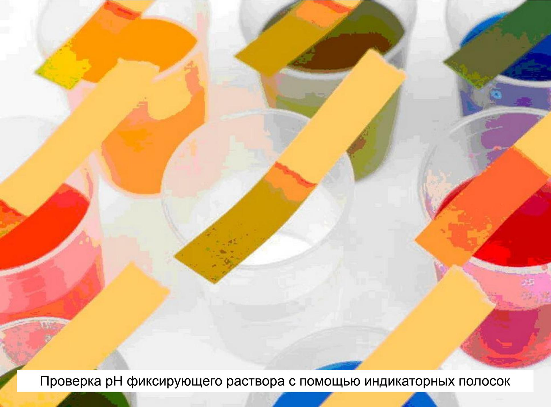
Проверка pH фиксирующего раствора с помощью индикаторных полосок
