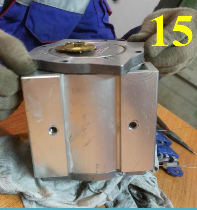
15. Поворачиваем фланец и аккуратно тянем его за углы вверх.
