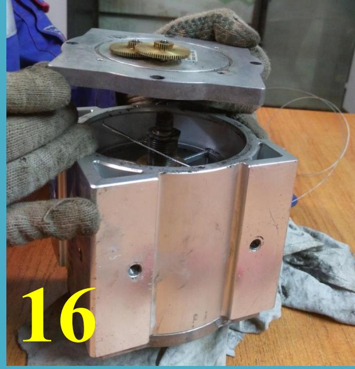
16. Снимаем фланец, стараемся не потерять шайбу и стопорное кольцо.
