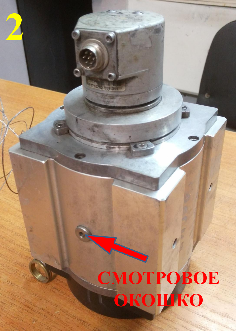
2. Энкодер в сборе с тросовым барабаном
