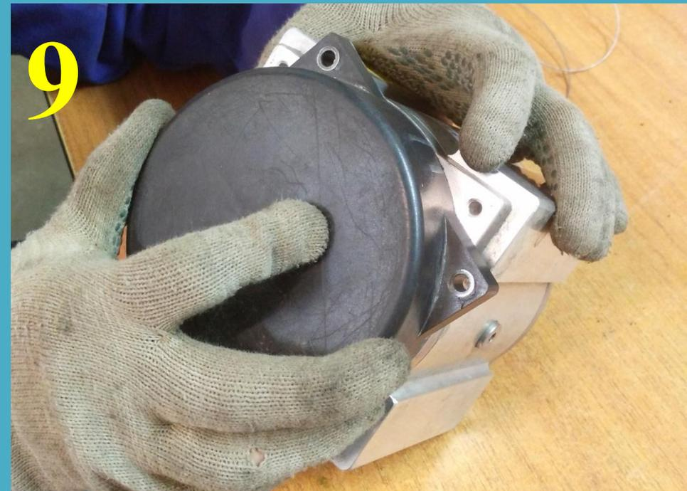
9. При помощи второй руки аккуратно поворачиваем крышку, ослабеваем натяжение пружины.
