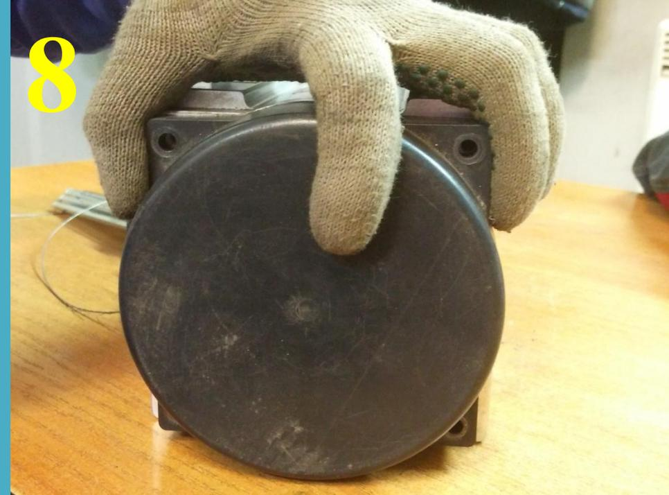
8. Прижимаем к корпусу крышку и не даём ей провернуться, так как пружина внутри находится в натяжении.
