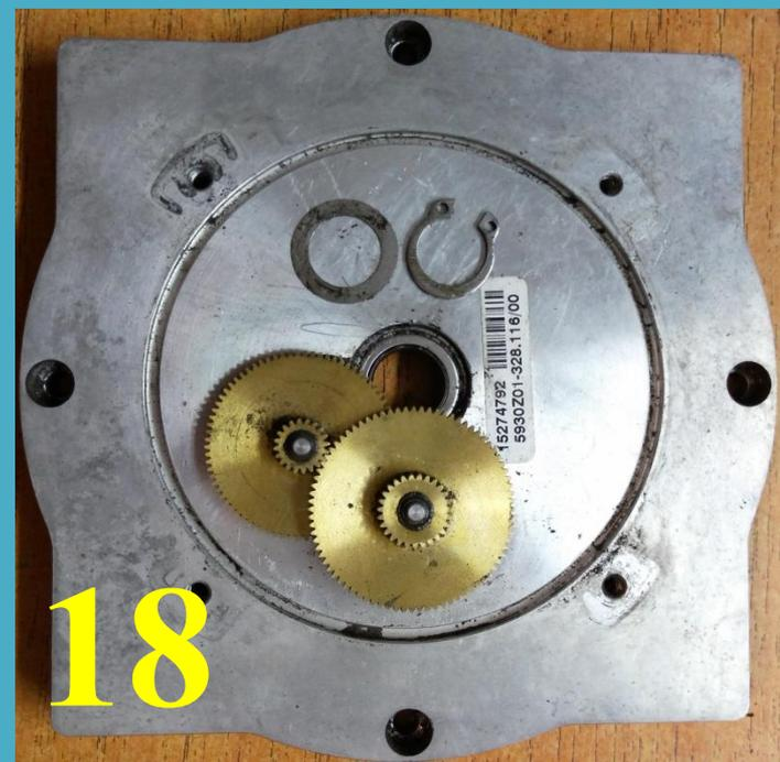
18. Снятый фланец с шестернями, шайба и стопорное кольцо.
