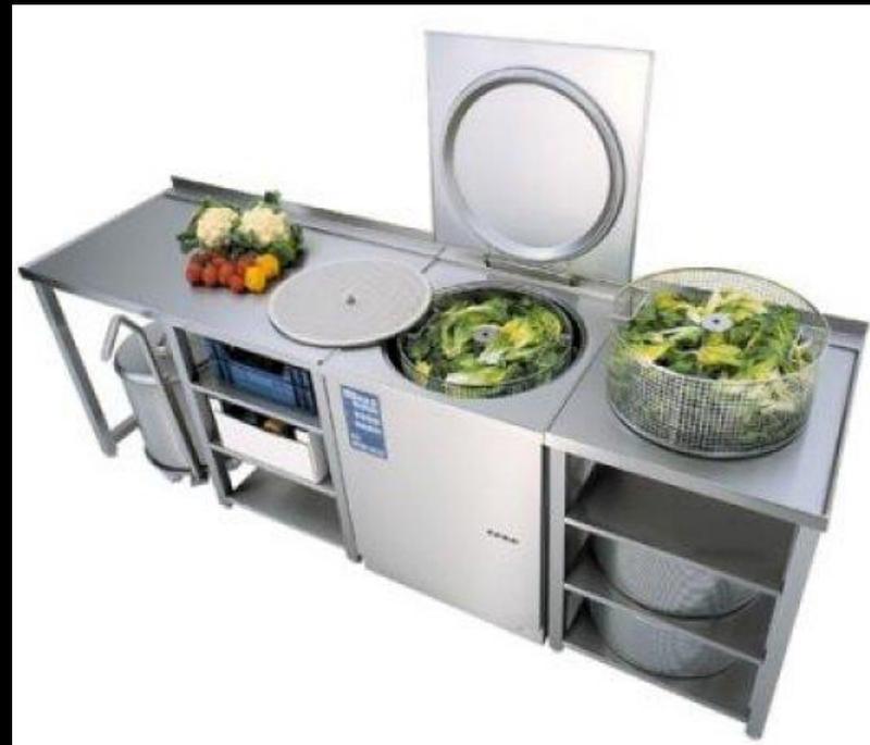
На линии обработки капусты и зелени устанавливают производственные столы, овощемоечную машину и моечную ванну.
