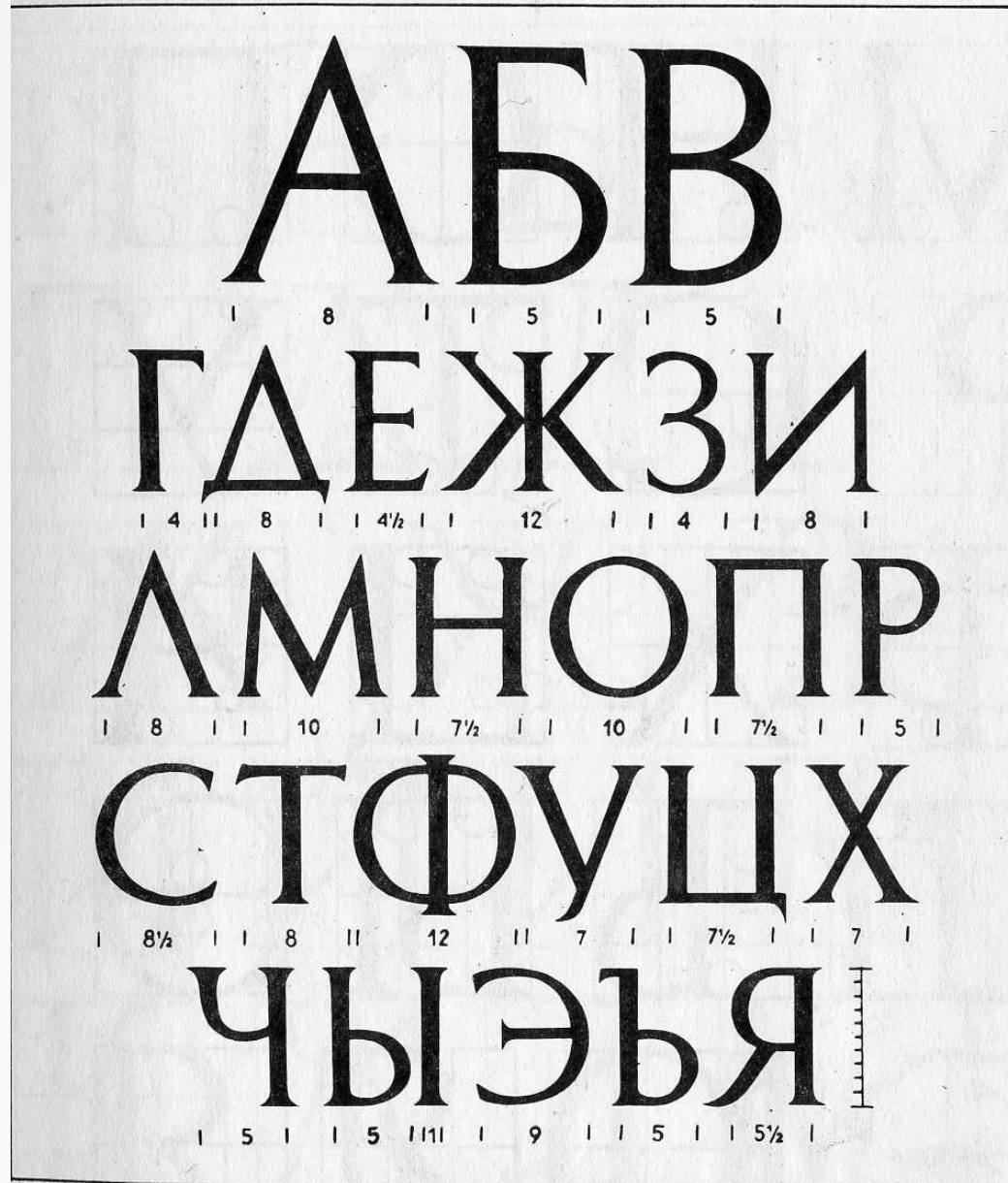
Рис. 63. Построение шрифта типа антиквы по модулю. Цифрами указана ширина букв относительно толщины основной стриха, т. е. модуля.
