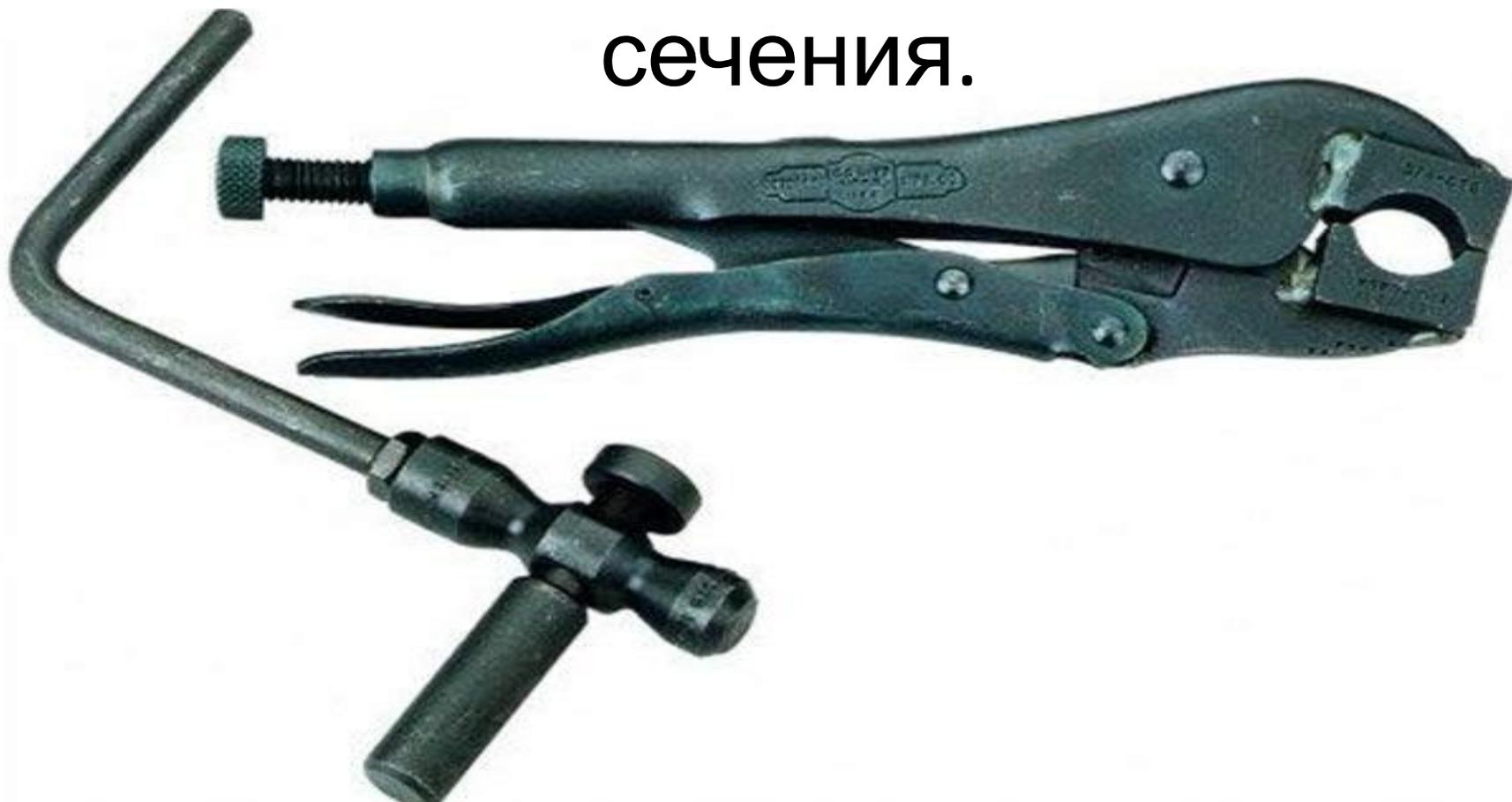
Уменьшить диаметр концевой части бывает нужно перед тем, как ручным способом нарезать на ней резьбу, или создать неразъемное плотное соединение трубы со штуцером. Для этого могут применяться обыкновенные клещи.
