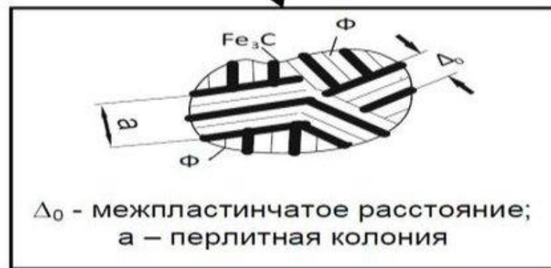
СХЕМА ПРЕВРАЩЕНИЯ АУСТЕНИТА В ПЕРЛИТ
