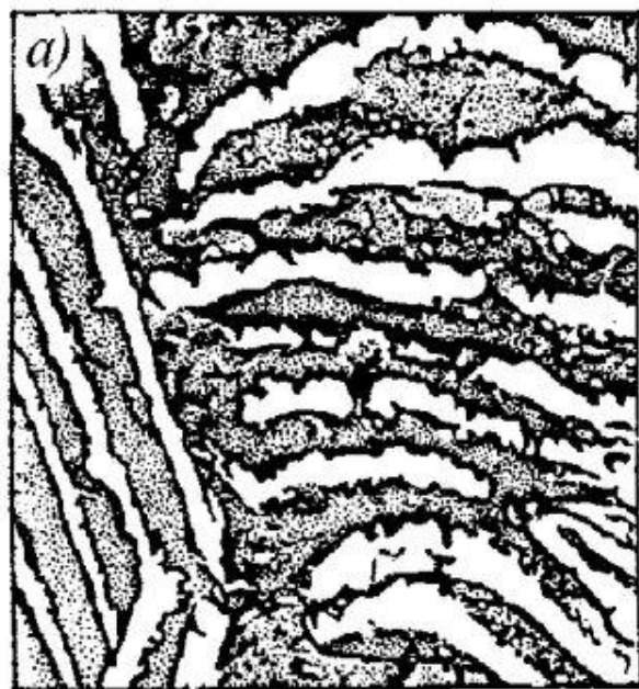
Структура перлита, сорбита и троостита
