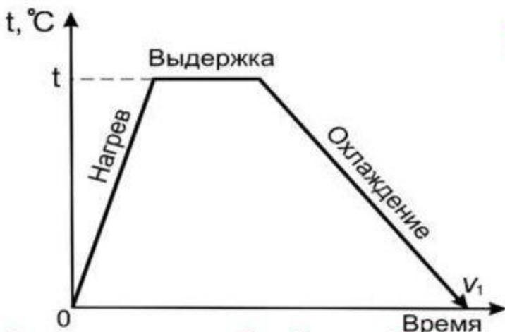
Режим термообработки (ТО) представляется графиком в координатах температура – время. Он характеризуется параметрами:
