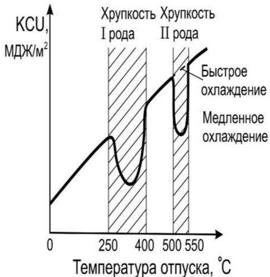
Влияние температуры отпуска на ударную вязкость стали
