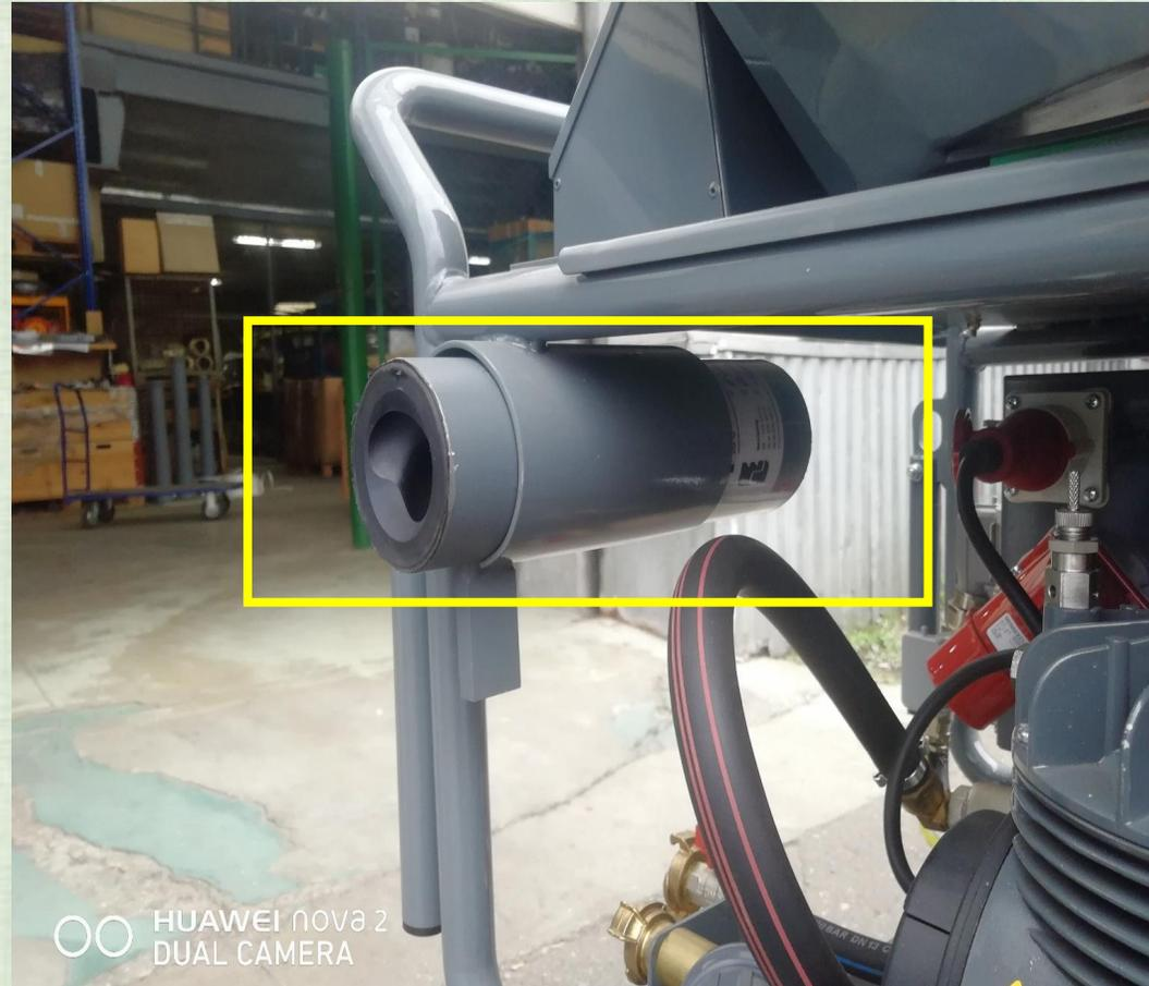
При работе с ёмкости, на дне всегда имеется большой осадок грязи, во время работы, грязь засоряет систему и этим выводит из строя дорогостоящие детали. Для лучшей очистки и долговечности работы водяного насоса, дополнительно установлен фильтр тонкой очистки.
