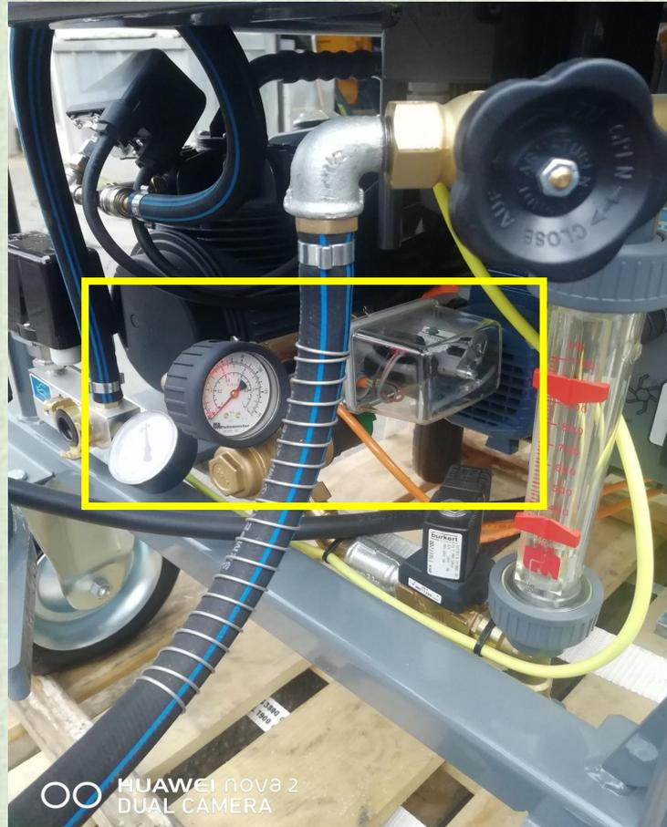
Конфигурация крышки эл. ящика была изменена. В верхней части детали, был добавлен дополнительный защитный бортик. Это дополнительная защита ящика от попадания сухой смеси, приводящей к выходу из строя компоненты электрооборудования.
