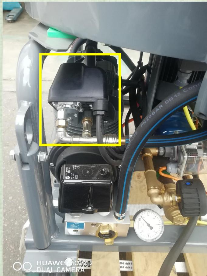
Регулирующий вентиль воды и расходомер, перенесены ближе к пульту управления. Благодаря этим изменениям все органы управления машины находятся под рукой. Оператору намного удобнее производить настройку и регулировку консистенции штукатурной смеси.
