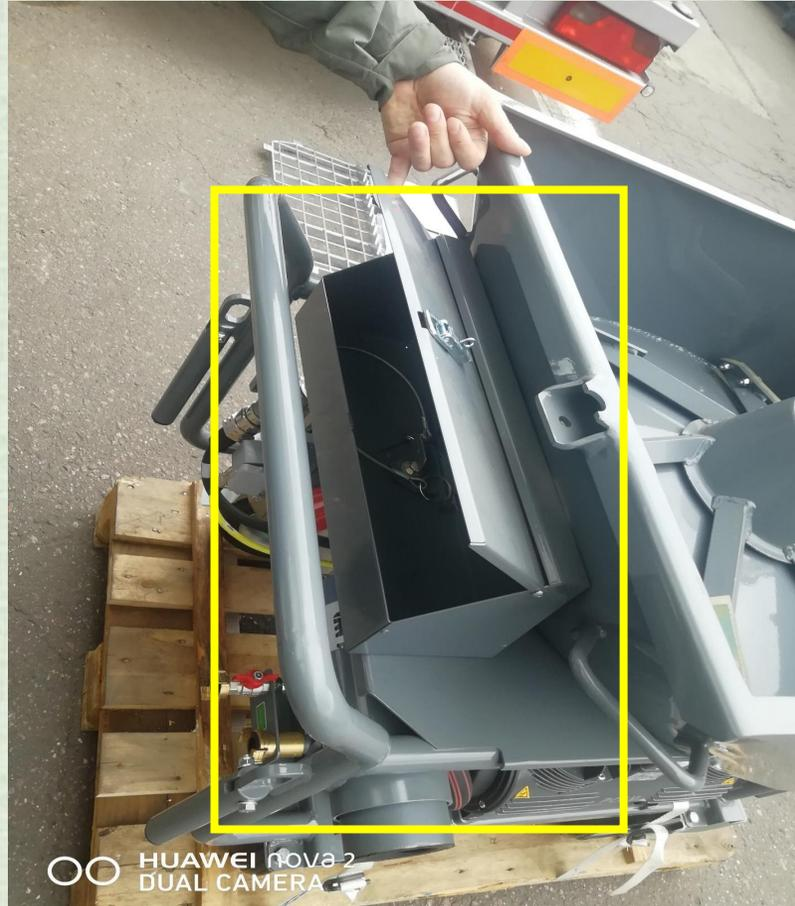
*Изменения также коснулись и компрессора. Был установлен новый более производительный и легко обслуживаемый агрегат с легким доступом к воздушным фильтрам.*
