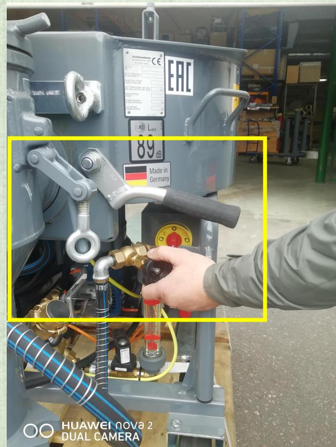
*Манометр давления воды и реле давления воды развернуты в сторону оператора. Это решение очень удобно в процессе эксплуатации.*
