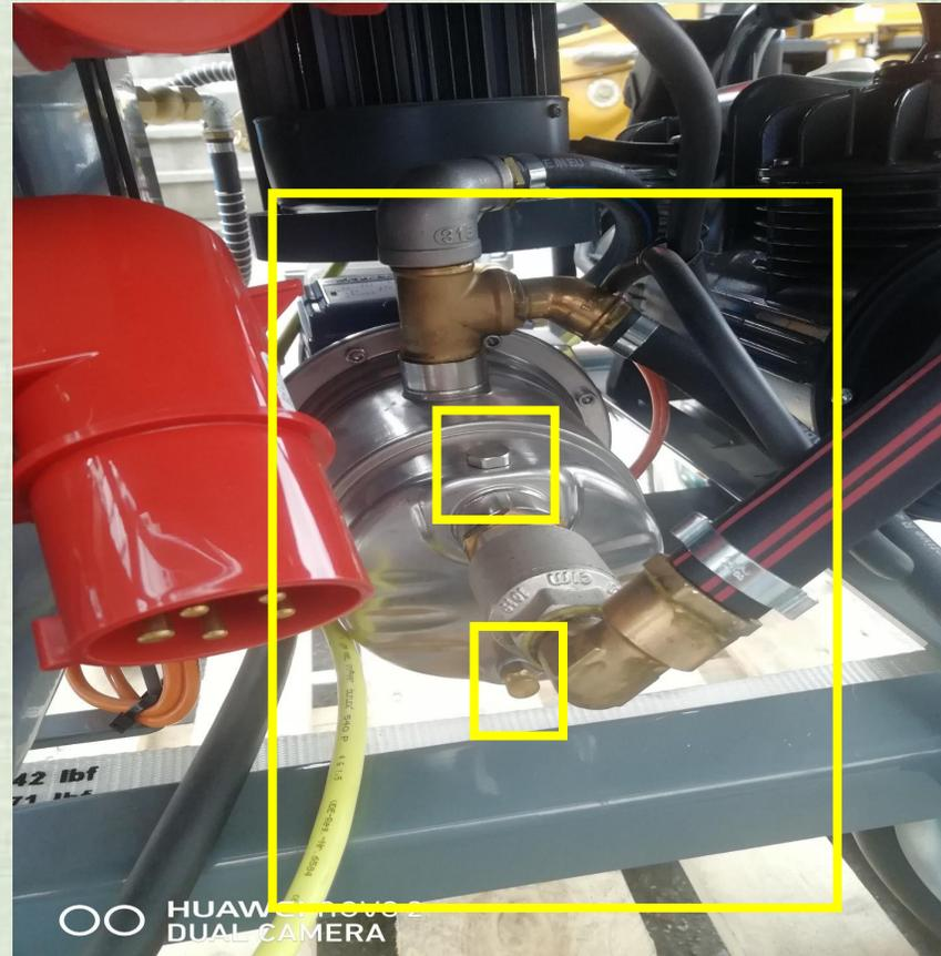
*Появилось удобное и практичное решение по разборке , и сборке шнекового насоса. С помощи этого фиксатора, можно легко и просто извлечь ротор из статора, не используя дополнительных инструментов.*
