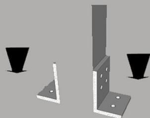
Принцип крепления фронтальных стоек к скальному основанию посредством дополнительных крепежей «лапок».
