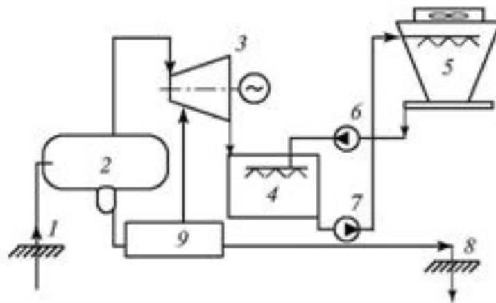
Рис. 4. Схема геотермальной электростанции с конденсационной турбиной и расширением геотермального флюида:
