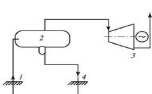
Рис. 2. 1 — подъемная скважина, 2 — сепаратор; 3 — паровая турбина с генератором; 4 — нагнетательная скважина.
