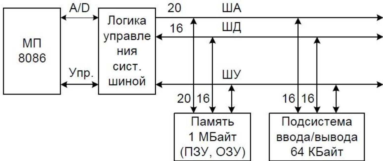
Рис. 1.1. Структура микросистемы на базе МП i8086
