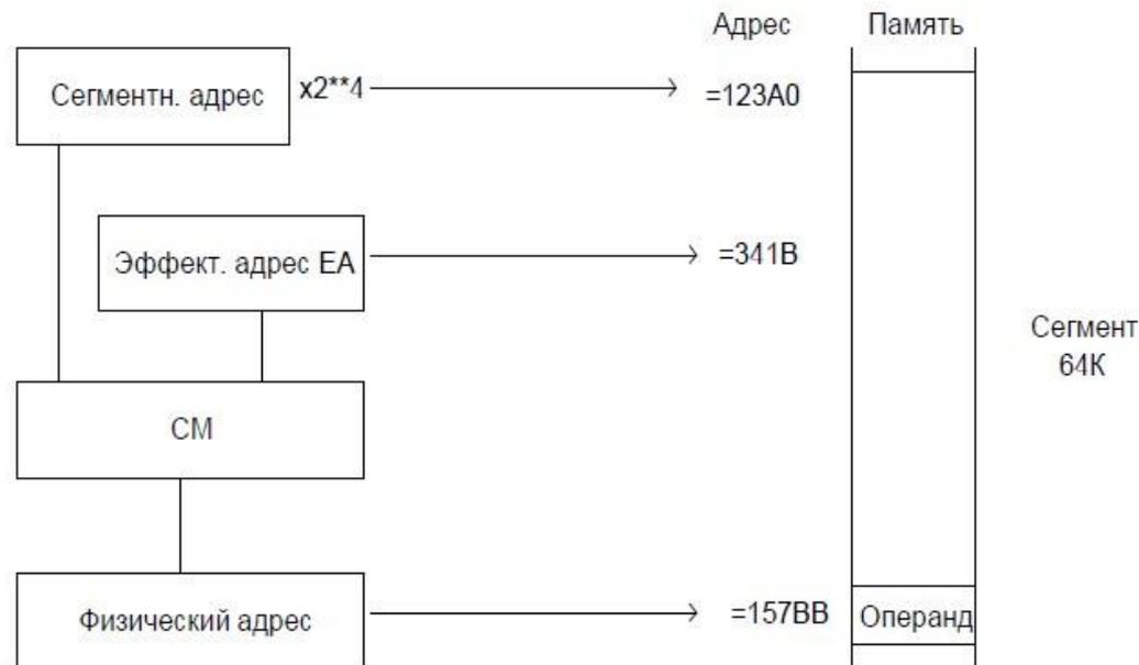
Рис. 1.3. Схема вычисления физического адреса
