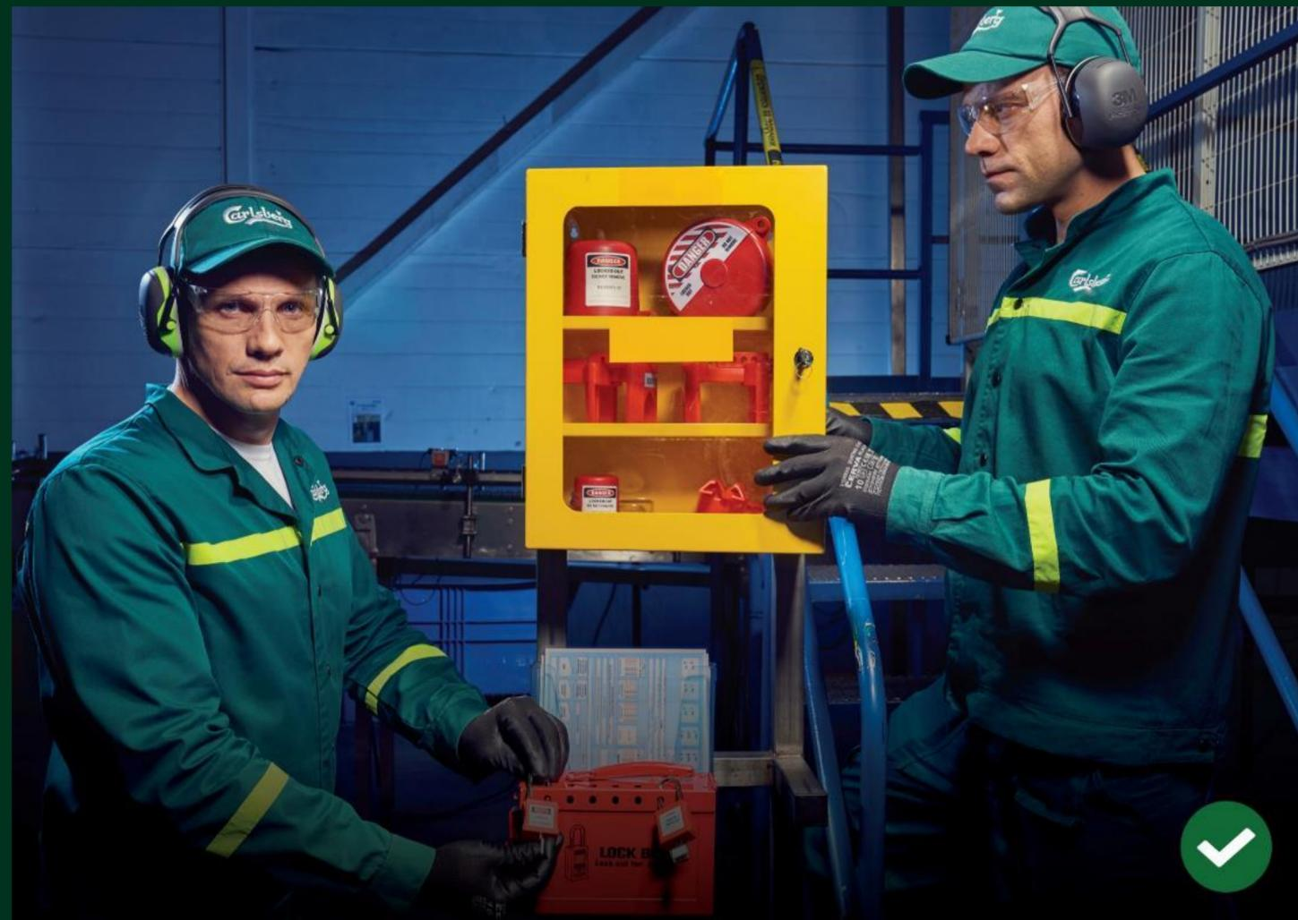
Групповой бокс — предназначен для упрощения процедуры блокирования больших участков оборудования. После разблокирования механизма или процесса ключ/ключи от замков помещаются в блокировочный бокс. Каждый авторизованный член бригады помещает свой персональный замок или блокиратор на групповой блокировочный бокс
