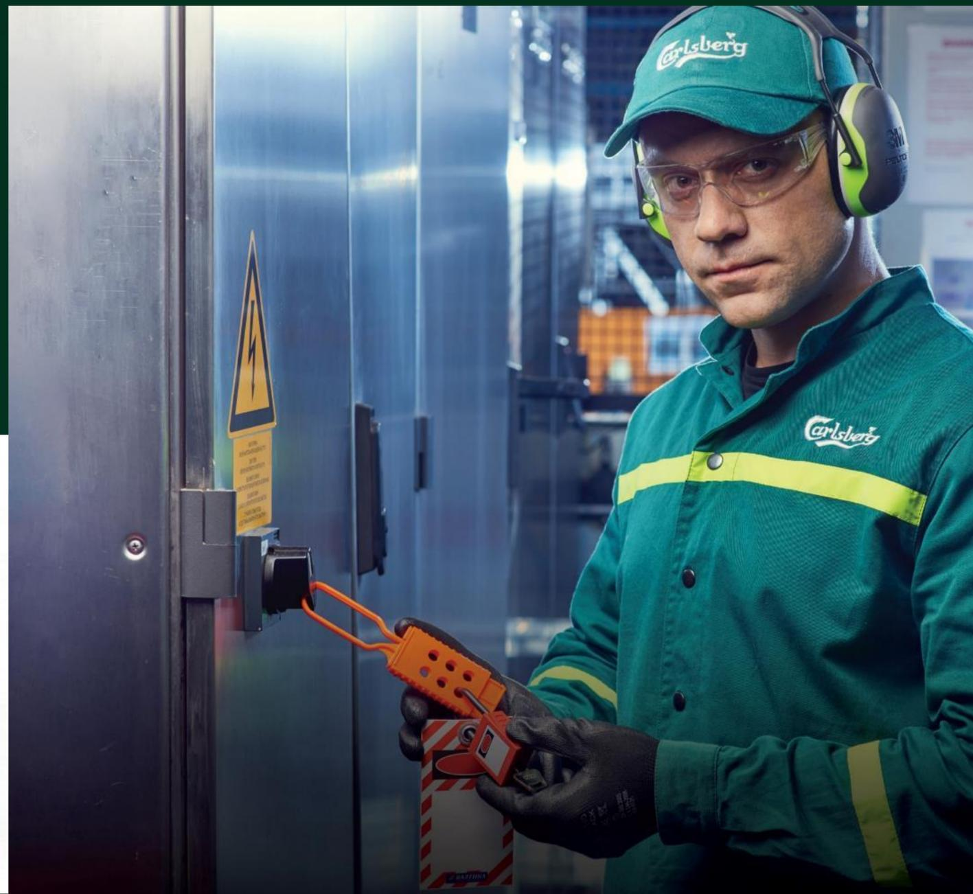
Блокировочная накладка (ХАСП) — используется в случае проведения работ несколькими сотрудниками одновременно и позволяет каждому сотруднику блокировать оборудование личным замком. При помощи блокировочной накладки (ХАСПа) можно одновременно размещать несколько навесных именных замков по месту блокирования оборудования и проведения ремонтных работ (например: пульт автомата).
