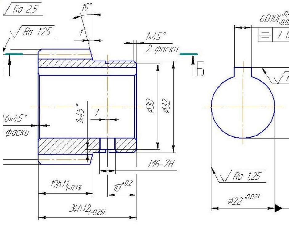
Деталь «Колесо зубчатое» изготовлена из стали 40Х ГОСТ4543-71.
