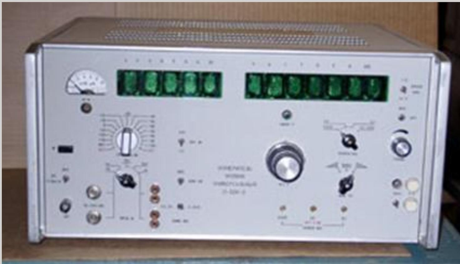
Он представляет собой **широкополосный и селективный измеритель уровня напряжения электрических сигналов** и предназначен для использования при измерениях параметров линий связи, каналов и трактов систем связи с частотным разделением каналов при их настройке, эксплуатации и ремонте.
