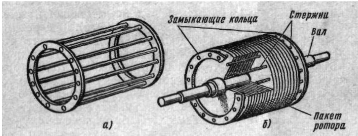
**Обмотку ротора в виде жесткой системы стержней с кольцами автор назвал «беличьей клеткой». Так как «беличья клетка» не имеет каких-либо соединений с внешней сетью и представляет собой короткозамкнутую систему проводников, ротор с этим типом обмотки принято называть короткозамкнутым.**
