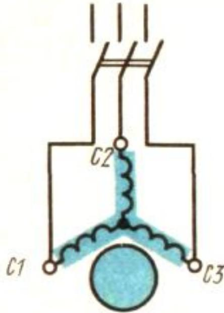
Пуск двигателя с короткозамкнутым ротором. Для двигателей с короткозамкнутым ротором обычно применяют прямое включение в сеть обмотки статора C1, C2, C3 с помощью соответствующей коммутационной аппаратуры.
