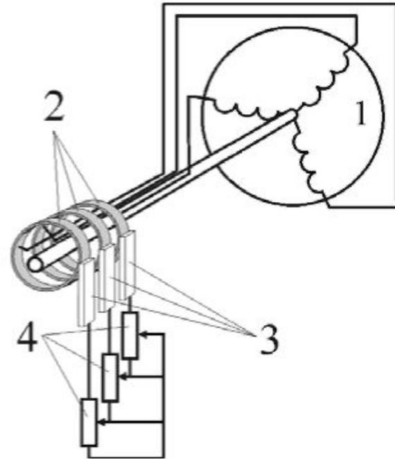
Хорошими пусковыми характеристиками обладает двигатель с фазным ротором. Для снижения пускового тока обмотки P1, P2, P3 ротора при пуске замыкают на активное сопротивление  $R_{доб}$  (4) пускового реостата ПР.
