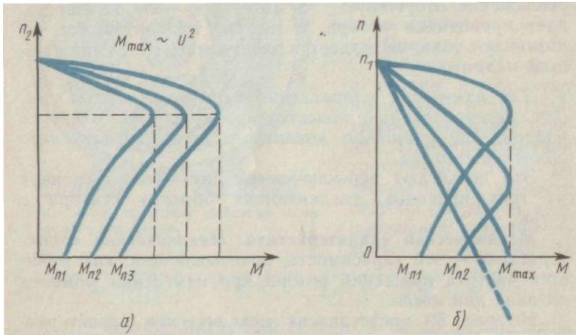
Рассмотрим наиболее простой случай, когда момент  $M_c$  не зависит от частоты. При включении двигателя его пусковой момент больше момента сопротивления (а) и ротор приобретает ускорение. Скорость возрастает до тех пор, пока не установится равенство моментов двигателя и сопротивления; при  $M_c = M_n$  ротор вращается с номинальной частотой  $n_n$ .
