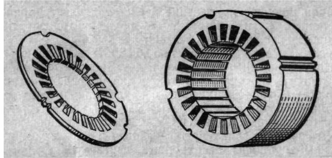
**Основными частями статора являются неподвижный пакет магнитопровода и трехфазная обмотка. Пакет магнитопровода изготовлен в виде полого цилиндра, набранного, так же как и магнитопровод трансформатора, из тонких листов электротехнической стали. Листы имеют форму колец с пазами, симметрично расположенными вдоль внутренней окружности.**
