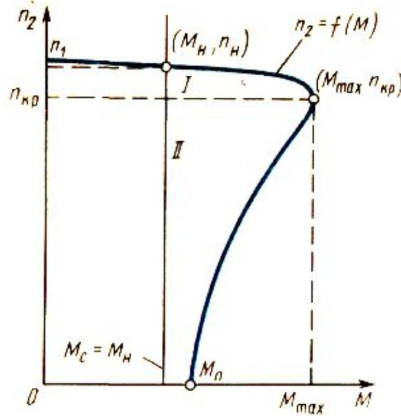
Характерные точки:  $O$ ,  $n_1$  — идеальный холостой ход;  $M_{\max}$ ,  $n_{кр}$  — максимальный момент, критическая частота вращения;  $M_H$ ,  $n_H$  — пусковой момент. Точкой  $M_{\max}$  кривая делится на две области: I — область устойчивой работы, где находится точка номинального режима ( $M_H$ ,  $n_H$ ); II — область неустойчивого режима, используемая при пуске или вынужденной остановке двигателя
