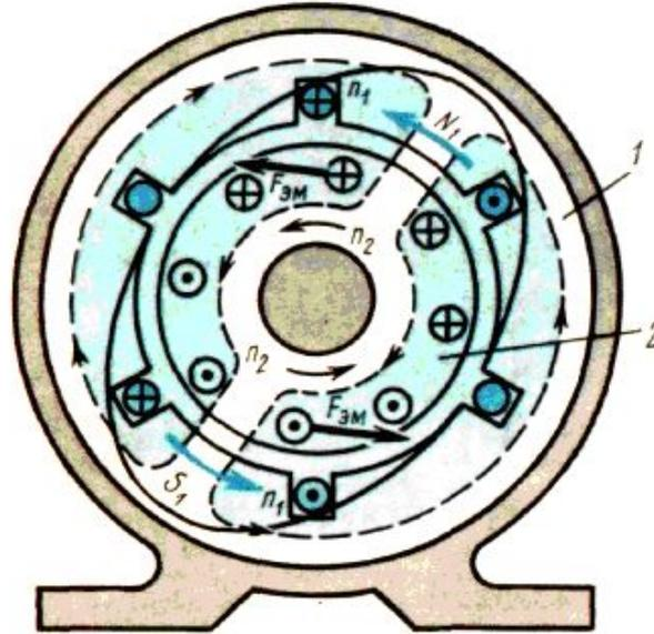
Сердечники статора 1 и ротора 2 образуют магнитную цепь асинхронной машины. При прохождении трехфазного тока по трехфазной обмотке статора создается вращающееся магнитное поле N1 — S1 частоты
