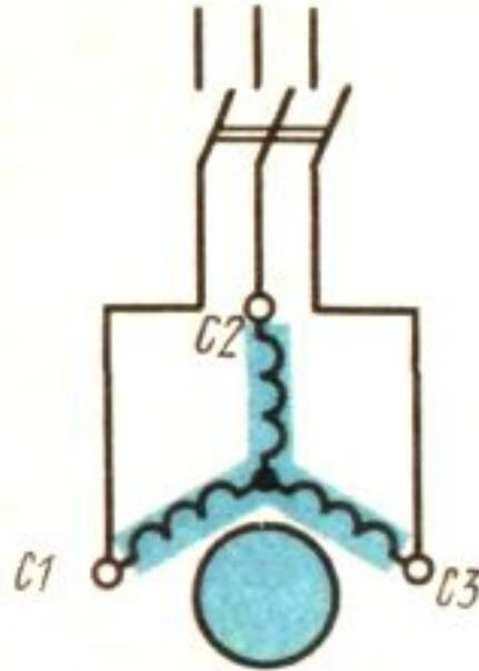
Напряжение в период пуска двигателя понижают: включая в цепь обмотки статора на период пуска добавочные активные или реактивные сопротивления (реакторы); подключая двигатель к сети через понижающий автотрансформатор. Общий недостаток всех способов — значительное уменьшение пускового и максимального моментов двигателя, пропорциональных квадрату приложенного напряжения.
