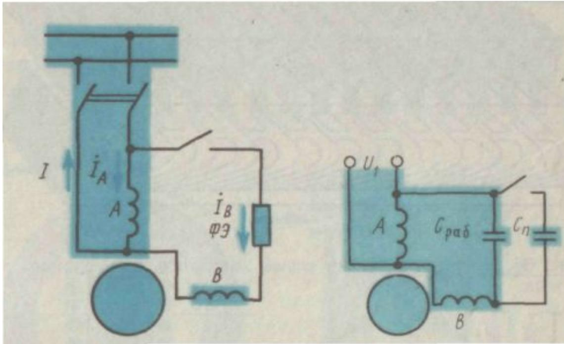
Это достигается включением в цепь пусковой обмотки фазосдвигающего элемента ФЭ: активного сопротивления или емкости. После запуска двигателя пусковая обмотка отключается. Движение поддерживается пульсирующим полем рабочей обмотки.
