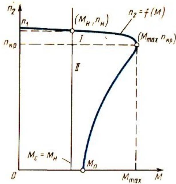
Механическая характеристика — это зависимость, показывающая, как меняется частота вращения ротора при изменении момента на валу двигателя.
