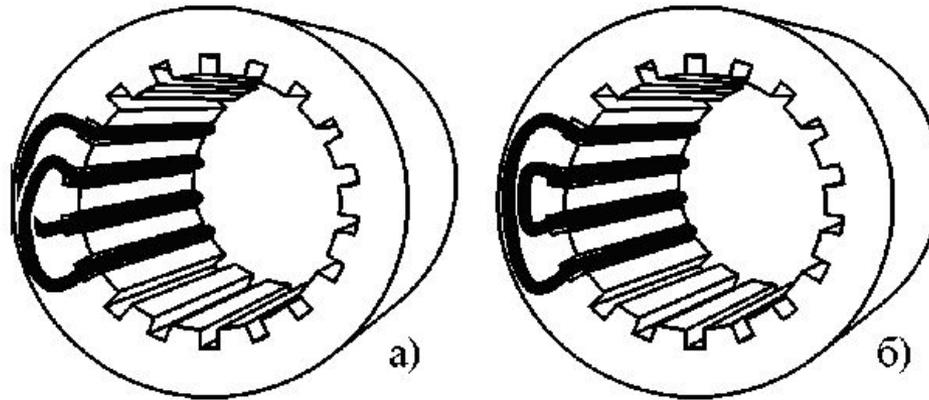
При этом катушки в группе могут быть одинакового размера, изготавливаться по шаблону и укладываться в пазы с одинаковым шагом между сторонами катушек. Такие обмотки называются шаблонными. Катушки могут быть также разных размеров и укладываться одна внутри другой. В этом случае обмотки называются концентрическими (рис. б).
