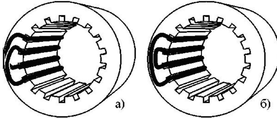
**Сосредоточенные фазные обмотки, т.е. обмотки представляющие собой одну катушку, стороны которой расположены в двух пазах статора, по ряду причин на практике не применяются. Обычно обмотка делится на несколько катушек, образующих катушечные группы, каждая из которых формирует полюс магнитного поля. Катушки распределяются по соседним пазам сердечника, и такая обмотка называется распределённой (рис. а).**
