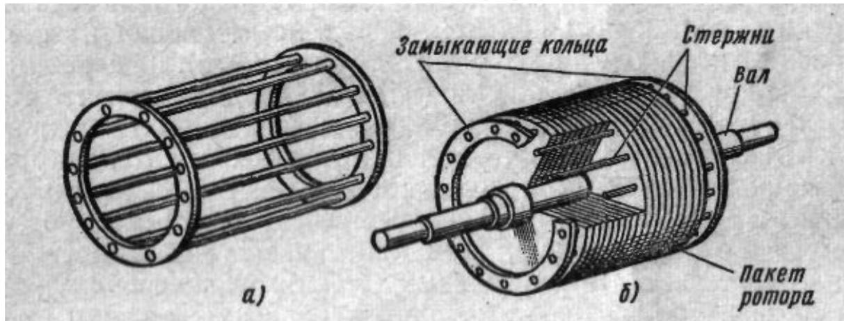
Первый тип обмоток был ротора разработан М. О. Доливо-Добровольским в 1889 г. Он предложил в пазы пакета ротора вставлять медные стержни, лишенные изоляции, а все концы стержней на обоих торцах пакета замыкать накоротко при помощи двух медных колец (рис. а). Такие медные стержни и кольца применяют в современных асинхронных машинах мощностью более 100 кВт (рис. б). В менее мощных машинах стержни изготовляют прямой заливкой пазов роторов расплавленным алюминием.
