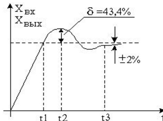
$$T_1 = 3,1 T_\mu, T_2 = 5,8 T_\mu, T_3 = 16,5$$
