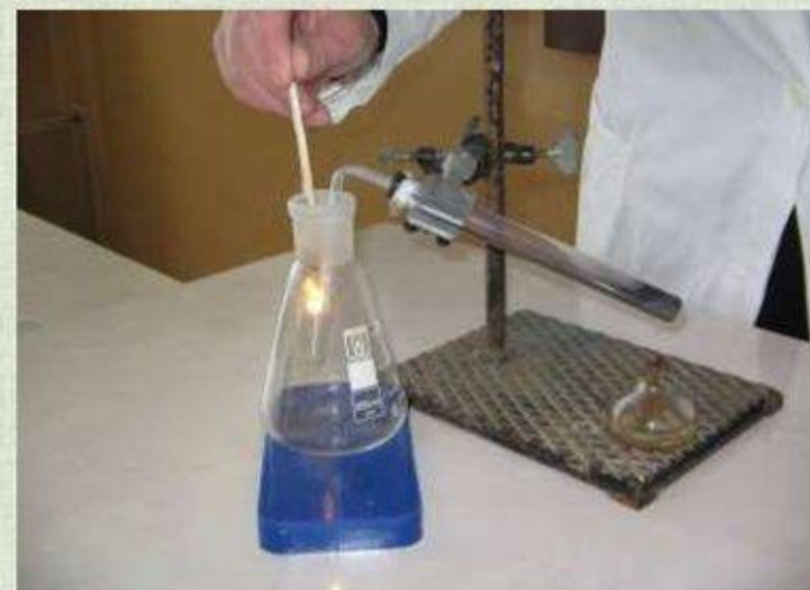
Проверка собранного кислорода
