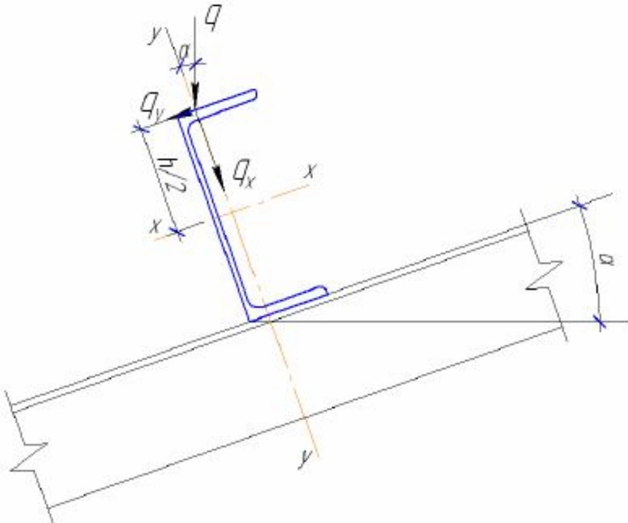
Рис. 22.2. Схема действия нагрузки на прогон
