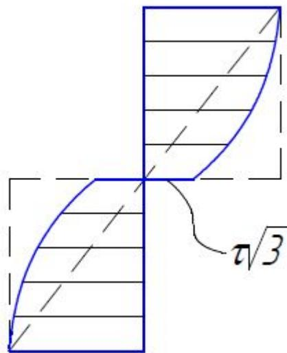
Отсюда следует, что развитие шарнира пластичности в сечении разрешается при ограниченных значениях касательных напряжений.
