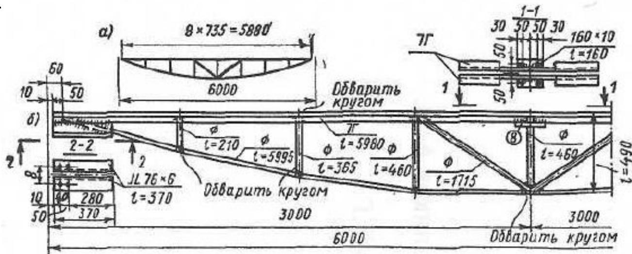
Рис. 22.6. Прутково-шпренгельный прогон: а – схема; б – конструкция
