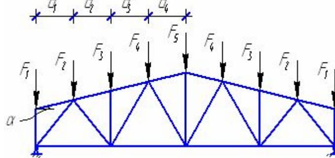
Рис. 19.1. Схема фермы с
