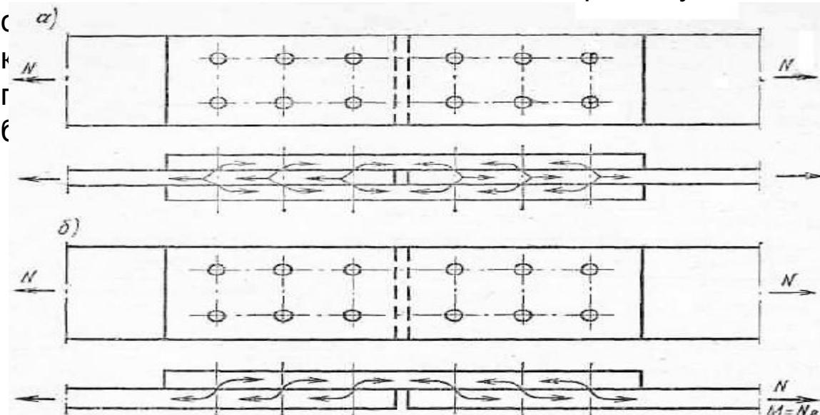
Стыки профильного металла (рис. 10.2) выполняют накладками: уголки – уголковыми, дву
