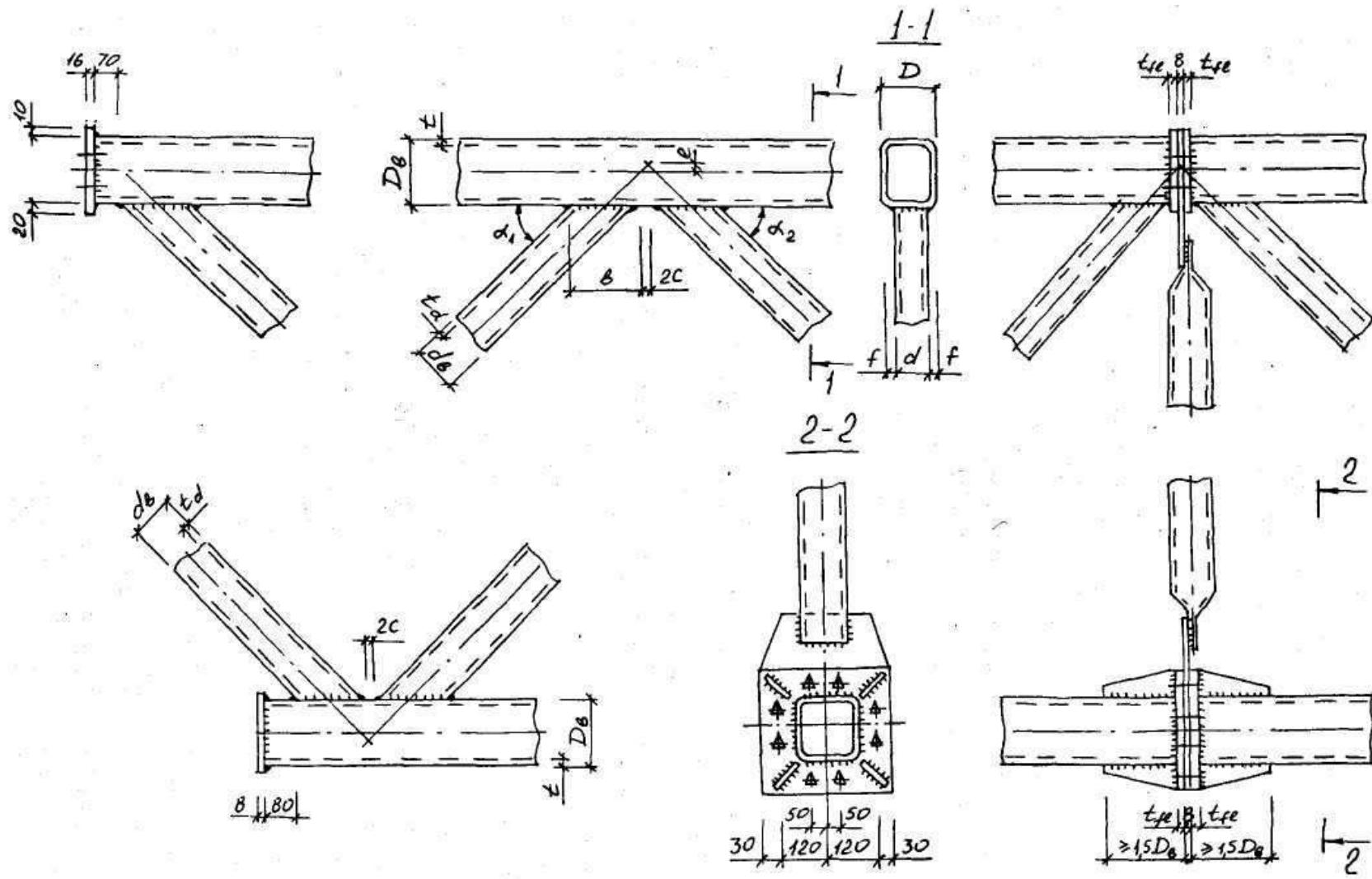
Рис. 21.2. Узлы ферм из замкнутых гнутосварных профилей
