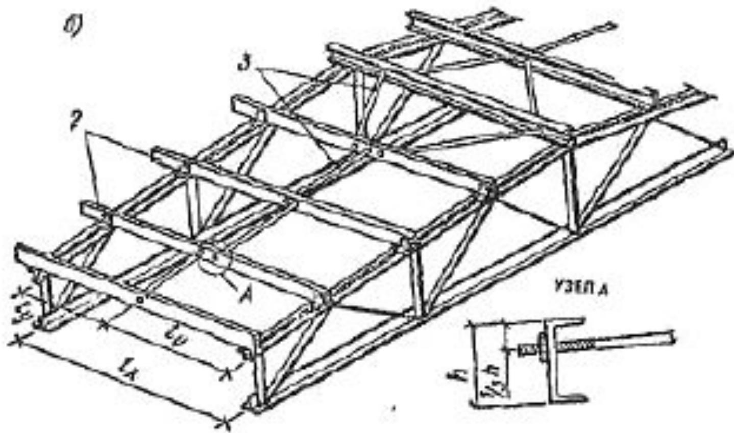
Рис. 22.4. Устройство тяжей.
