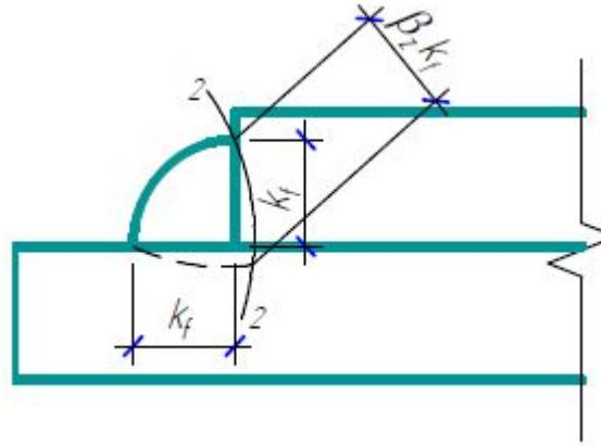
2-2 – плоскость разрушения по металлу границы сплавления.
