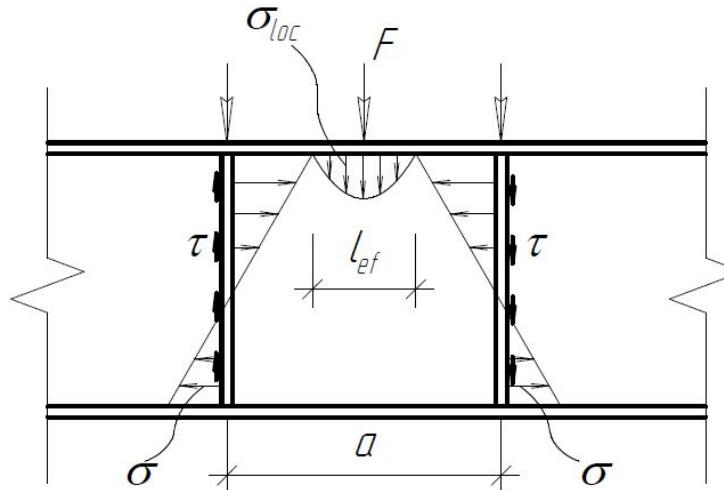
При расчете на местную устойчивость рассматривают отсек стенки ограниченный по горизонтали поясами и по вертикали смежными ребрами жесткости.
