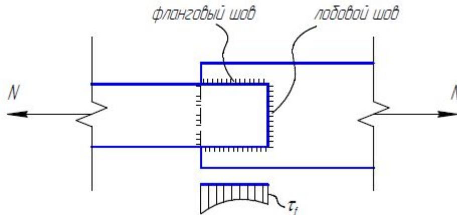
По длине фланговый шов работает неравномерно, причем, чем длиннее фланговый шов, тем больше наблюдается неравномерность распределения напряжений по длине углового шва.
