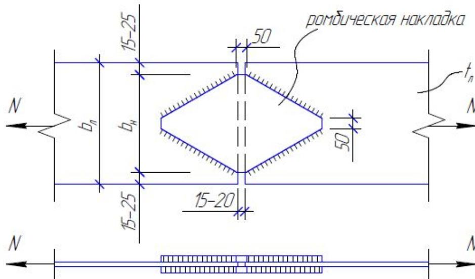
Порядок расчета соединения на ромбических накладках:
