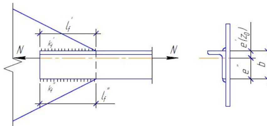
Определяют усилия приходящиеся на обушок и на перо ( $N'$  и  $N''$ ). Затем, в зависимости от способа сварки (автоматической быть не может) принимаются коэффициенты  $\beta_f$  и  $\beta_z$ .
