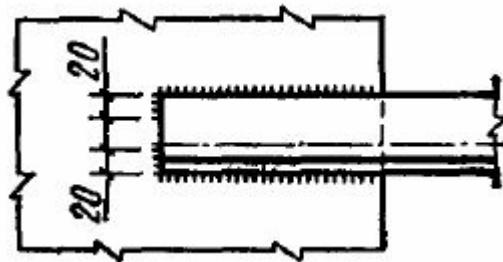
Рис. 20.5. Схемы выведения швов на торец элемента
