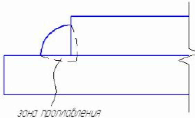
Глубина проплавления зависит от способа сварки.
