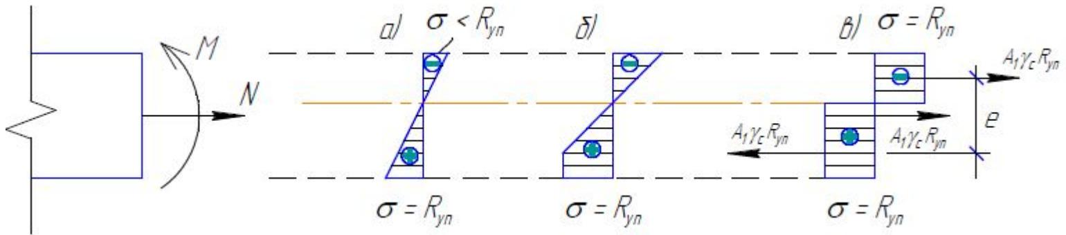
Очевидно, что разность площадей эпюр напряжений, умноженная на  $R_{yн}$ , равна предельной продольной силе:
