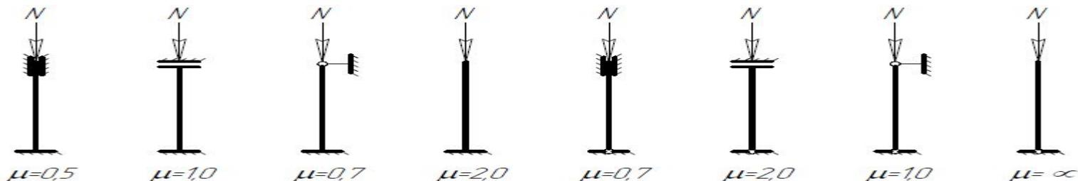
Рис. 13.3. Коэффициенты свободной длины для различных вариантов закрепления стержней.
