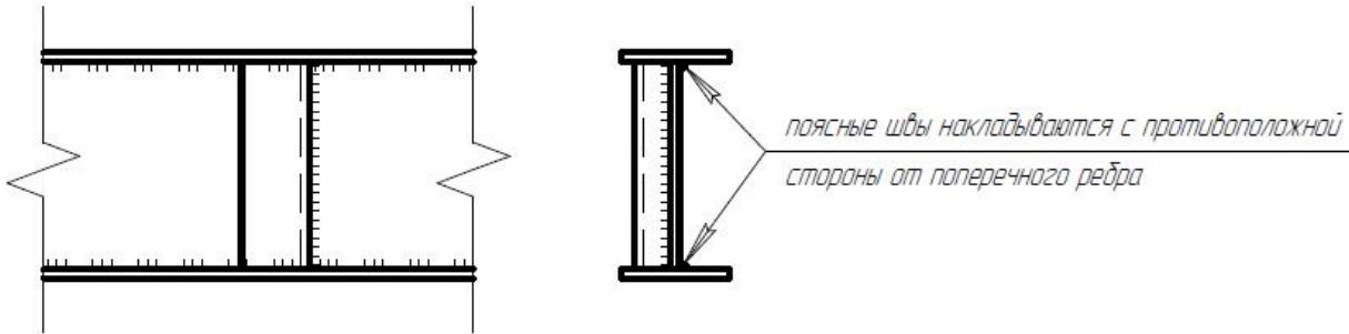
Стенки сварных балок для каждой схемы ребер жесткости рассчитываются на местную устойчивость по своим формулам.
