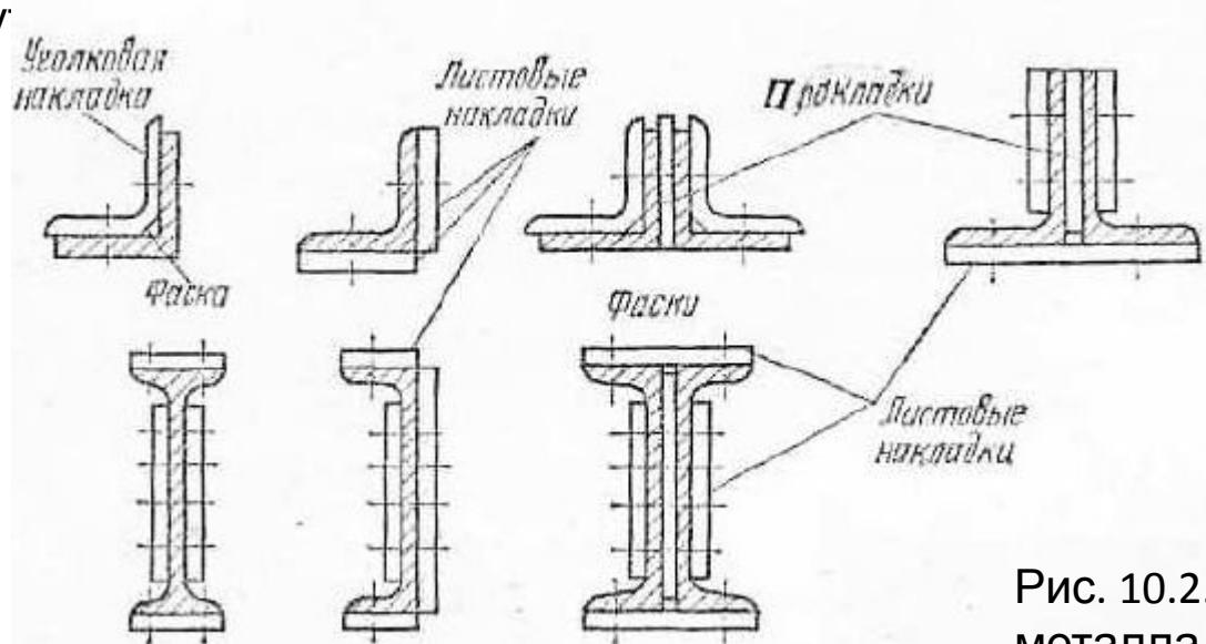
Рис. 10.2. Стыки профильного металла
