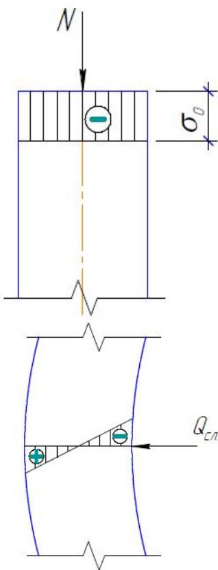
В тот момент, когда стержень имеет прямолинейную форму, нормальные напряжения по сечению распределяются равномерно (т.к. стержень центрально сжат).
