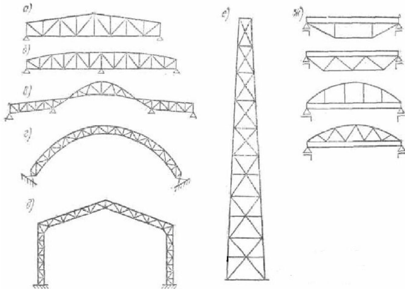
Рис. 15.1. Системы ферм: а – балочная; б – неразрезная;
