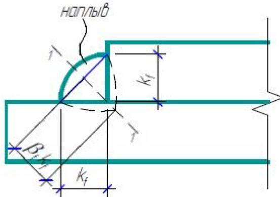
1-1 – плоскость разрушения по металлу шва.
