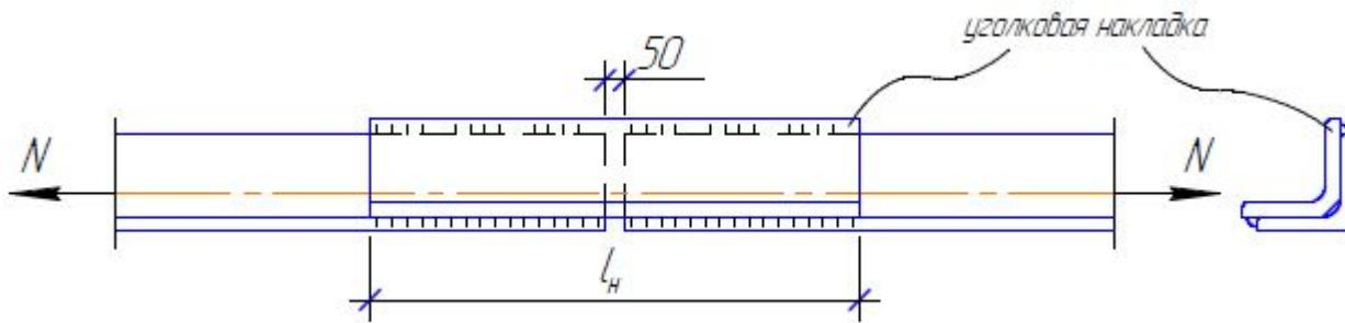
У уголковой накладки обушок срезается. В соответствии со СНиП сварные швы в таком соединении следует накладывать вдоль действующего усилия (фланговые швы). Длина накладок  $l_h$  зависит от длины швов. Требуемая длина швов определяется на половину соединения.
