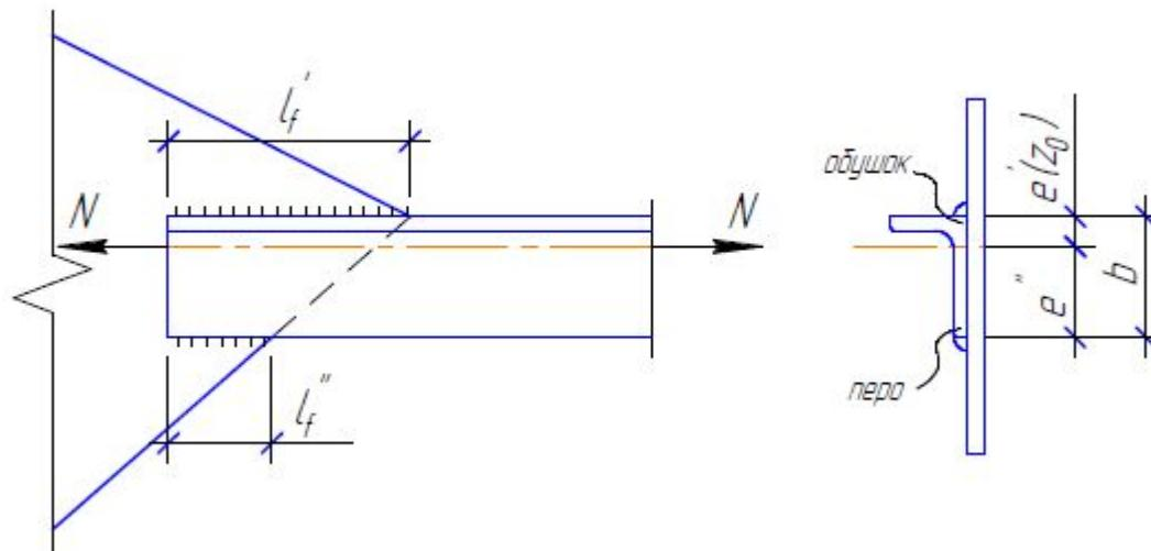
**При различной длине сварных швов по перу и по обушку и одинаковом  $k_f$**
