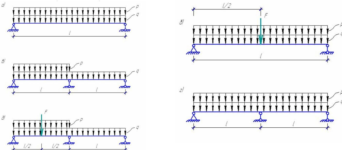
Рис. 23.1. Расчетные схемы кровельного настила:
