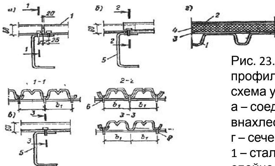
Рис. 23.3. Крепление стального профилированного настила к прогонам и схема утепленного покрытия.
