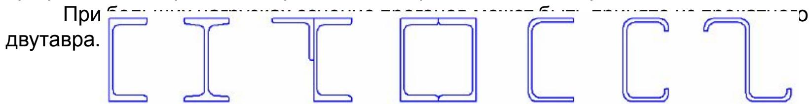
Рис. 22.1. Типы сечения сплошных прогонов
