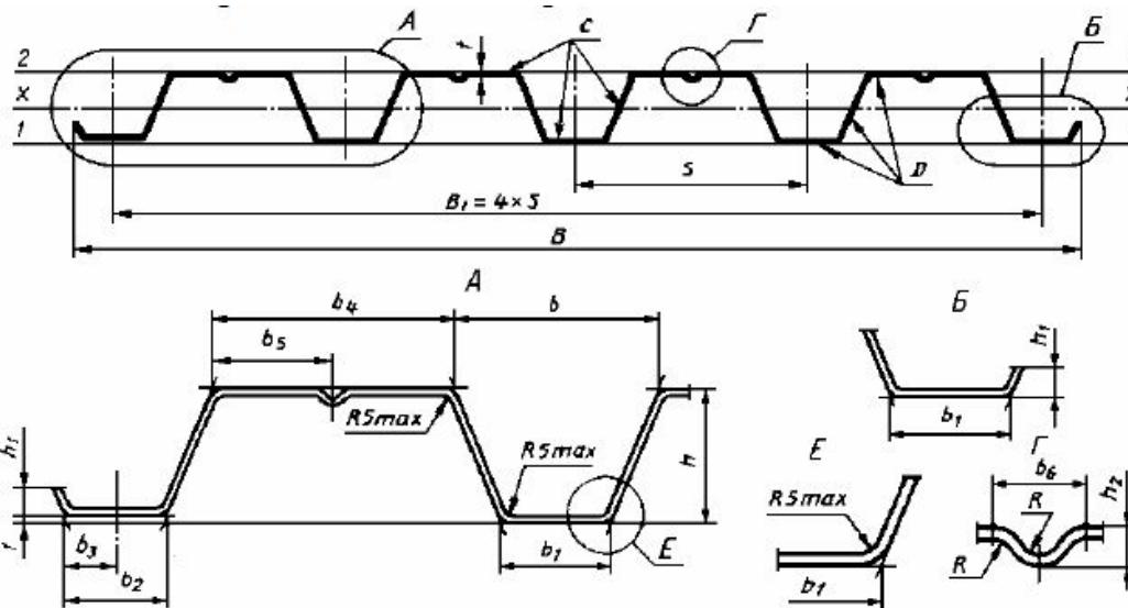
Рис. 23.2. Профилированный лист типа Н высотой 57 и 60 мм.
