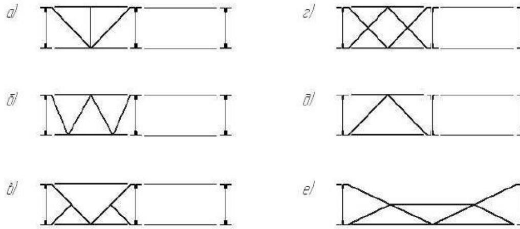
Рис. 18.2. Схемы решеток вертикальных связей между фермами
