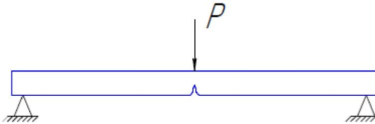
5) загиб полосы в холодном состоянии вокруг оправки на 180°. Это свойство устанавливает склонность стали к ра
