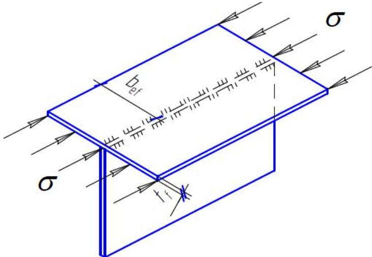
Сжатый пояс балки представляет собой длинную пластинку, шарнирно закрепленную одной стороной (вдоль стенки).
