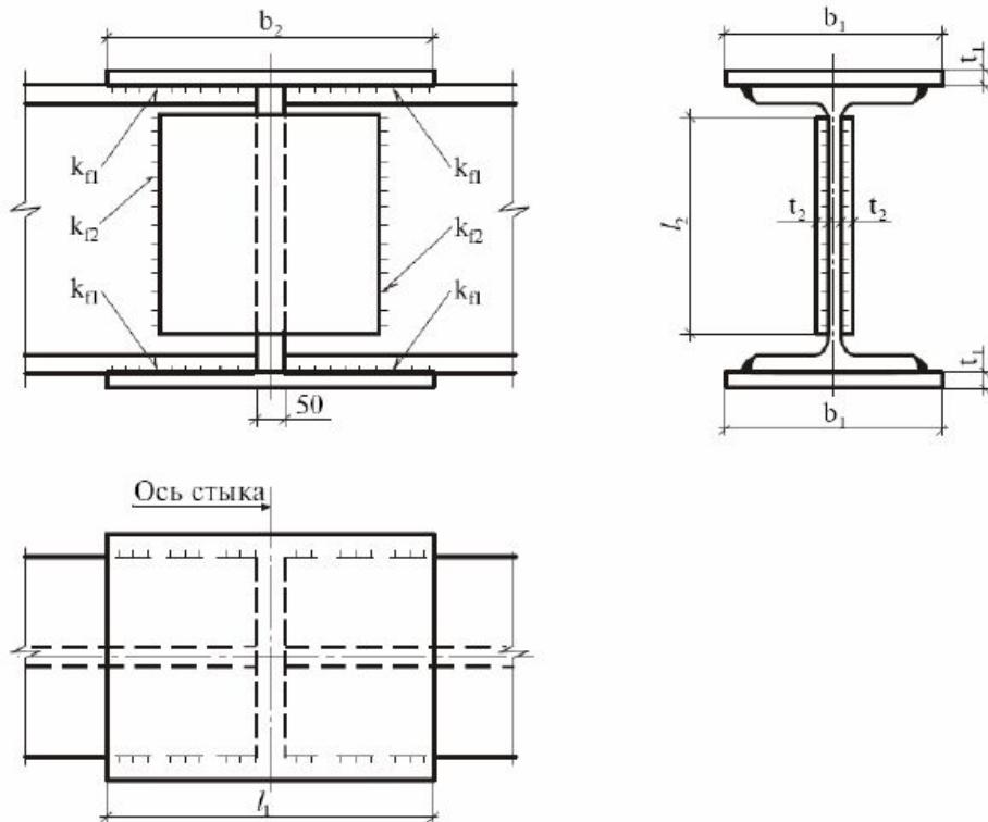
Все размеры накладок определяются расчетом по несущей способности соединяемых элементов.
