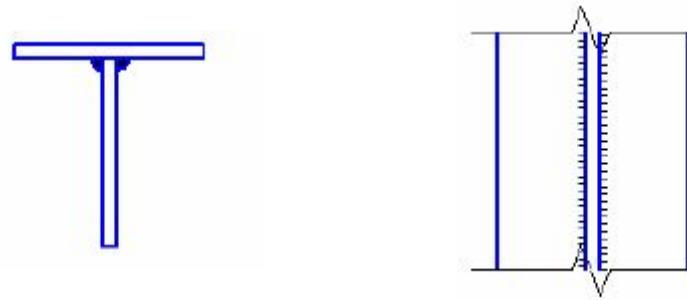
Угловые и тавровые соединения выполняют угловыми швами, они характеризуются простотой изготовления, высокой прочностью, экономичностью и широко применяются в конструкциях.
