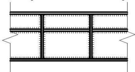
Продольные ребра жесткости могут располагаться как выше оси балки, так и ниже и устанавливаются в сварных балках высотой более 2 м.
