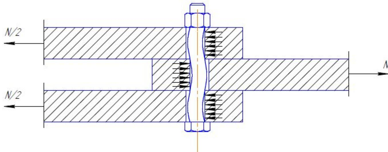
Болты класса точности В и С за счет зазора 2...3 мм работают неравномерно. 1 этап работы соединения – преодоление силы трения. Затем болты касаются стенок отверстия и работают частично на срез и частично на смятие.
