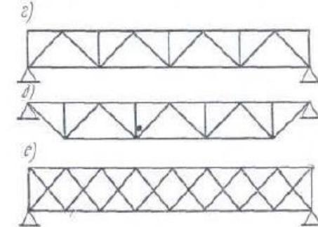
Рис. 15.3. Очертания балочных ферм:
