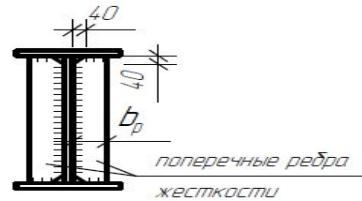
$$b_p \geq \frac{h_{ef}}{30} + 40(\text{мм})$$
