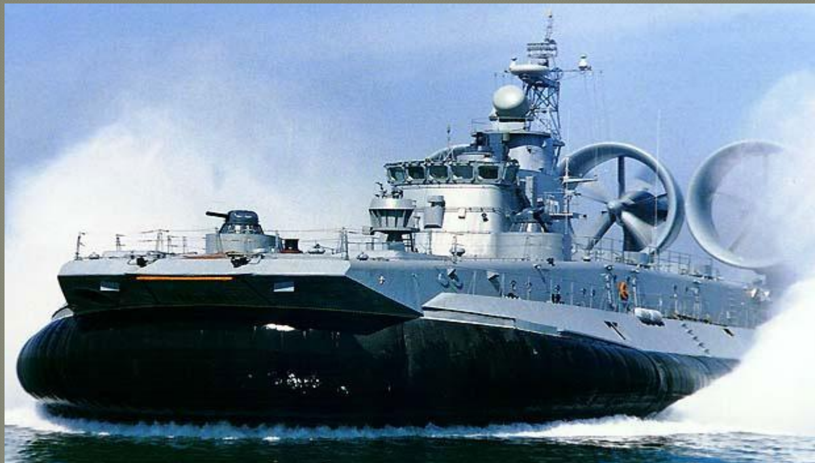
Средний десантный корабль на воздушной подушке «проект 11322»
