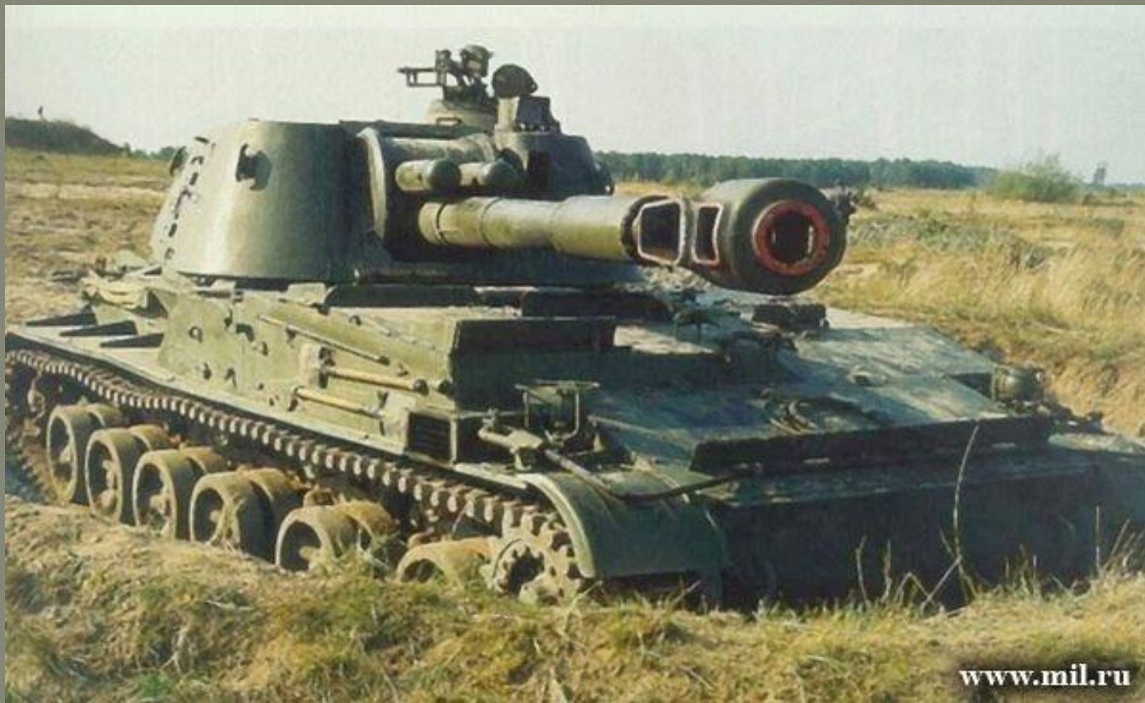
152-мм самоходная гаубица 2С3М1 «Акация»
