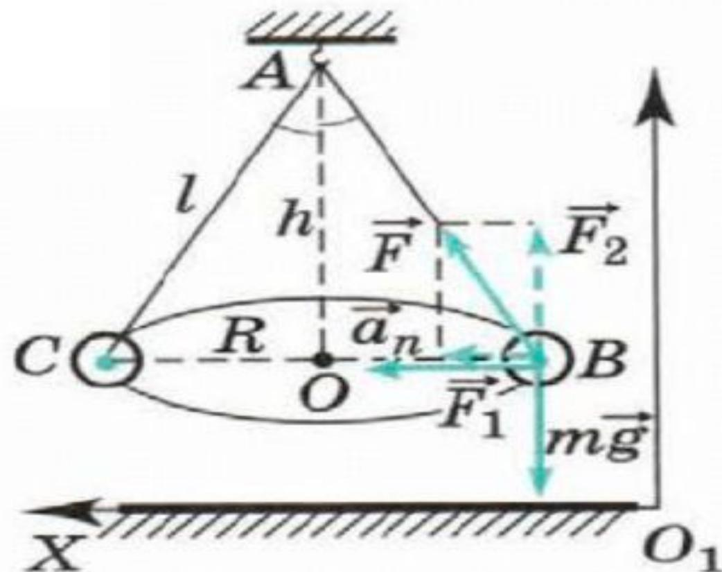
Эксперименты проводятся с коническим маятником. Небольшой шарик движется по окружности радиусом  $R$ . При этом нить  $AB$ , к которой прикреплён шарик, описывает поверхность прямого кругового конуса. На шарик действуют две силы: сила тяжести  $m\vec{g}$  и сила натяжения нити  $\vec{F}$ , которую можно разделить на две составляющие: горизонтальную  $\vec{F}_1$  и вертикальную  $\vec{F}_2$ .
