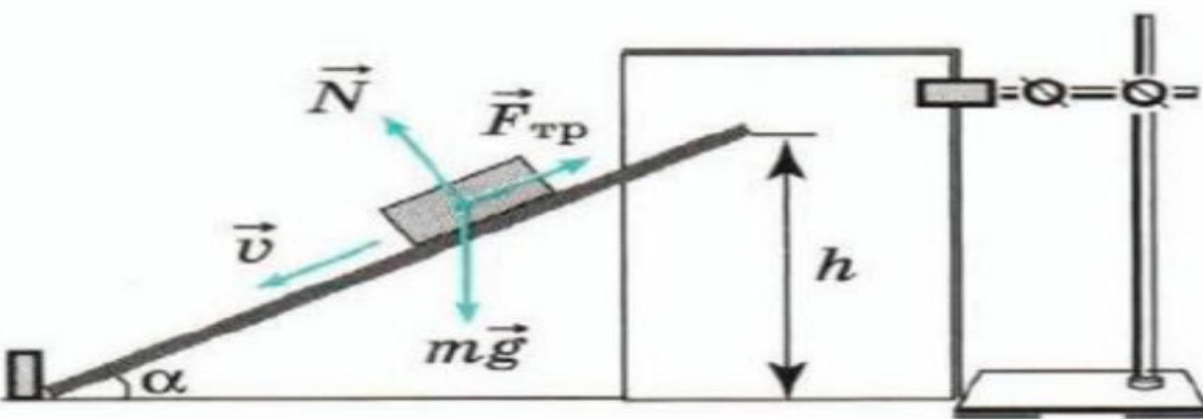
Сила трения скольжения направлена в сторону, противоположную относительной скорости тел, и равна:  $F_{тр} = \mu N$ .
