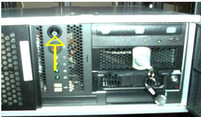
4.2 Включить сервер связи нажатием кнопки включения питания на передней панели
