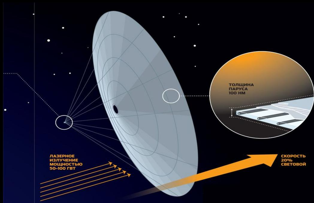
**Солнечный парус** (также называемый **световым парусом** или **фотонным парусом**) — приспособление, использующее давление солнечного света или лазера на зеркальную поверхность для приведения в движение космического аппарата.
