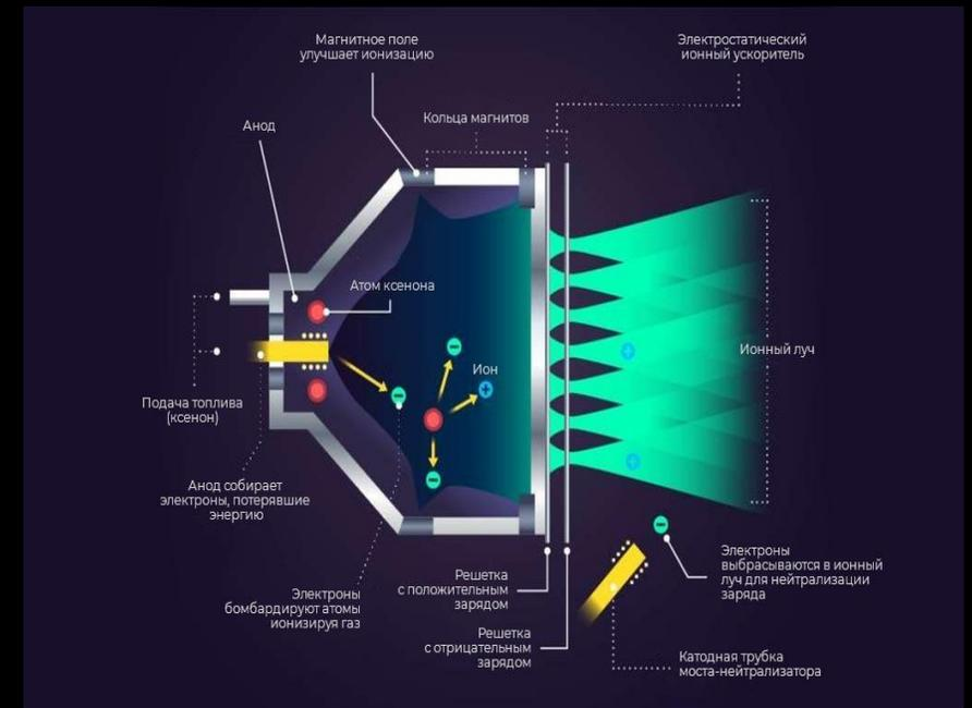
**Ионные двигатели** используют пучки ионов — электрически заряженных атомов или молекул — для создания тяги. Основным рабочим телом ионизации является газ, иногда ртуть. В ионизатор подается это топливо, после чего туда же запускают высокоэнергетические электроны. В этой камере образуется смесь из положительных ионов и отрицательных электронов.
