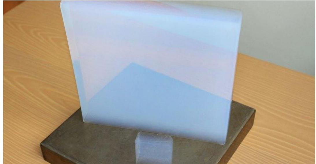
Размер скоплений частиц в аэрогелях порядка 2-5нм. Поры до 100нм
