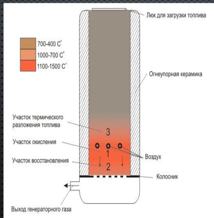
Газогенератор опрокинутого или обращенного процесса
